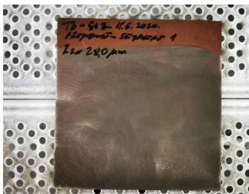
Slika 20. Izgled površine čelične ploče 3 pripravljene prema normi ISO 8504-3:2000, stupanj čistoće St 2.
