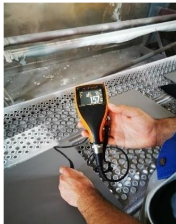
Slika 6. Primjer određivanja hrapavosti pomoću uređaja
