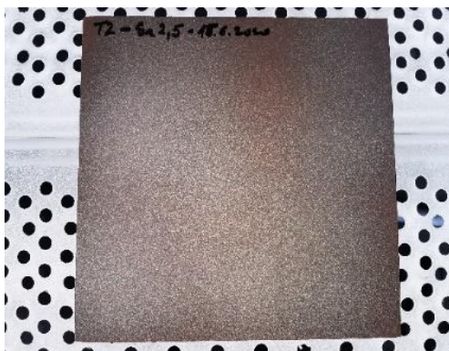
Slika 19. Izgled površine čelične ploče 2 pripravljene prema normi HRN EN ISO 8504-2:2004, stupanj čistoće Sa 2 1/2 .
