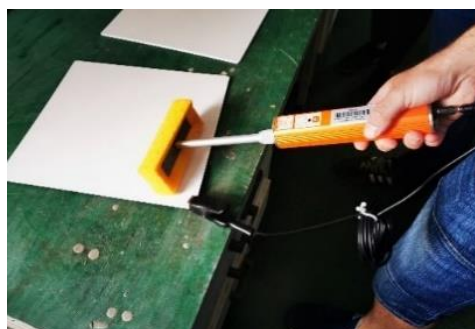
Slika 14. Određivanje poroznosti premaza pomoću uređaja Elcometer 270.
