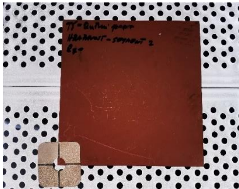
Slika 5. Primjer određivanja hrapavosti površine pomoću komparatora
