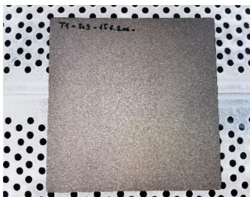
Slika 18. Izgled površine čelične ploče 1 pripremljene prema normi HRN EN ISO 8504-2:2004, stupanj čistoće Sa 3.
