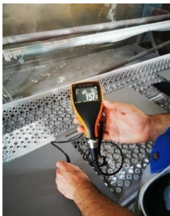
Slika 6. Primjer određivanja hrapavosti pomoću uređaja
