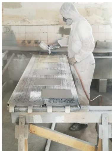
Slika 10. Postupak nanošenja drugog premaza Hempadur quattro 17634/22090.
