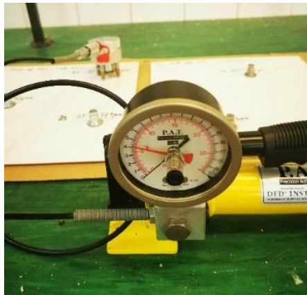
Slika 16. Uređaj PAT model GM04/20kN Adhesion Tester DFD®.
