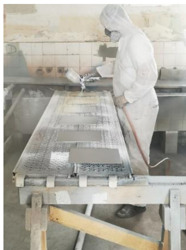
Slika 10. Postupak nanošenja drugog premaza Hempadur quattro 17634/22090.
