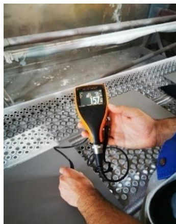
Slika 6. Primjer određivanja hrapavosti pomoću uređaja
