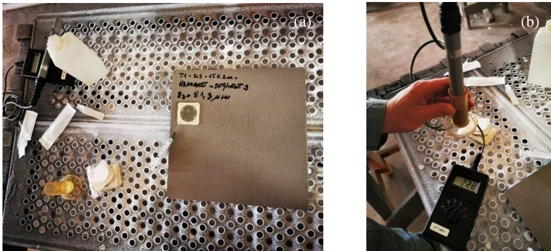
Slika 7. (a) Elcometer 138 Bresle komplet za utvrđivanje soli na površini i (b) konduktometrijsko određivanje provodnosti.
