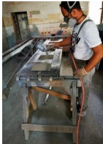
Slika 9. Postupak nanošenja prvog premaza Hempadur 155707/12340.
