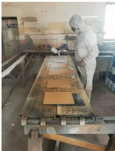
Slika 11. Postupak nanošenja završnog premaza Hempathane Topcoat 55210/10000.
