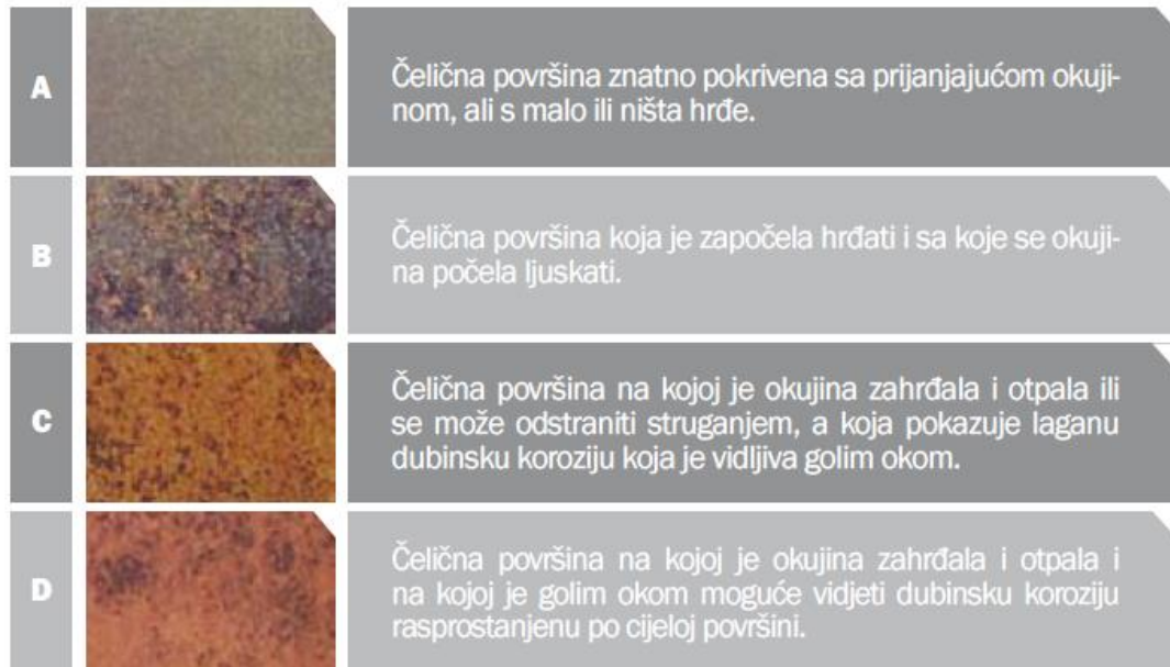
Slika 2. Početna stanja na čeliku: A, B, C i D identificirana standardom ISO 8501-1. 9
