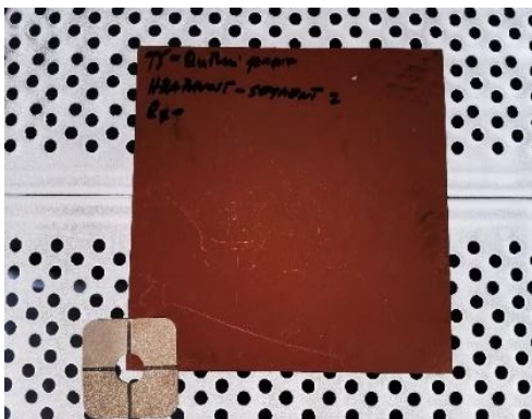
Slika 5. Primjer određivanja hrapavosti površine pomoću komparatora
