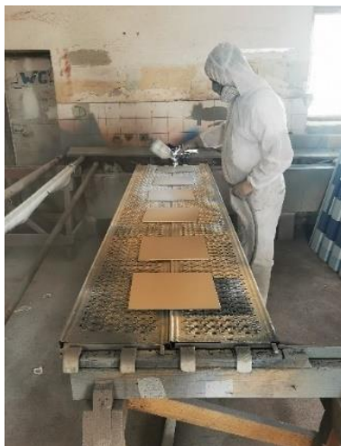
Slika 11. Postupak nanošenja završnog premaza Hempathane Topcoat 55210/10000.
