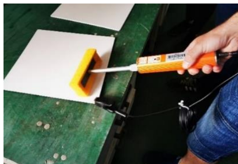
Slika 14. Određivanje poroznosti premaza pomoću uređaja Elcometer 270.
