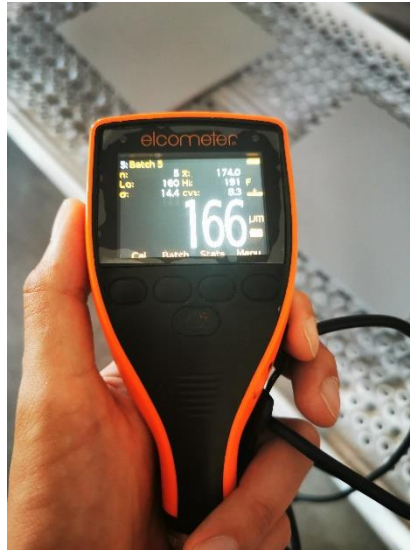
Slika 13. Elcometer 456 mjerac debljine suhog filma
