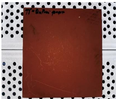
Slika 22. Izgled površine čelične ploče 5 pripravljene ručno brusnim papirom.
