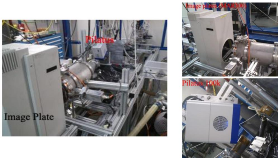
Slika 20. Eksperimentalni postav za prikupljanje SAXS i WAXS signala na SAXS liniji na sinkrotronu Elettra 171
