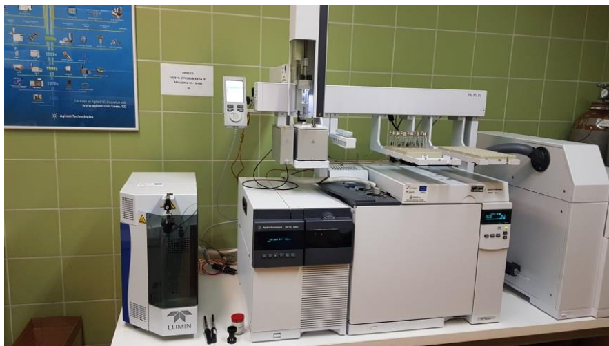
Slika 8. Vezani sustav plinska kromatografija-spektrometrija masa (GC-MS)
