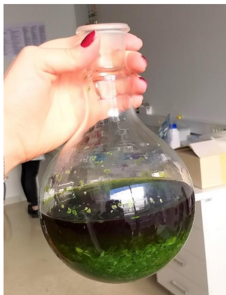
Slika 9. Prikaz uzorka u otopini 50%-tnog EtOH nakon mikrovalne ekstrakcije
