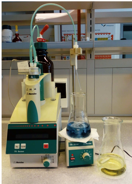
Slika 2.1. Promjena boje pri kompleksometrijskom određivanju olova
