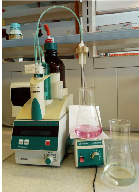
Slika 2.2. Promjena boje pri kompleksometrijskom određivanju cinka
