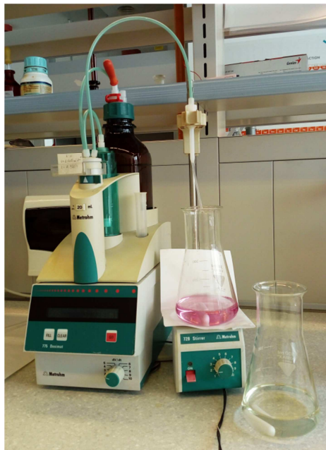
Slika 2.2. Promjena boje pri kompleksometrijskom određivanju cinka
