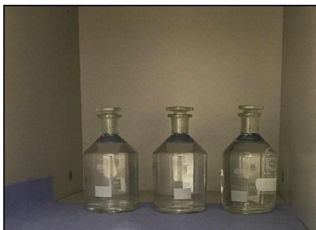
Slika 2.6. Winkler boce za određivanje sadržaja kisika nakon 5 dana s uzorcima i reagensima tijekom inkubacije
