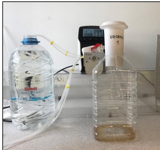
Slika 2.1. Dobivanje procjedne vode komine masline
