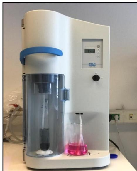
**Slika 2.7.** Uredaj za destilaciju i određivanje sadržaja dušika metodom po Kjeldahlu
