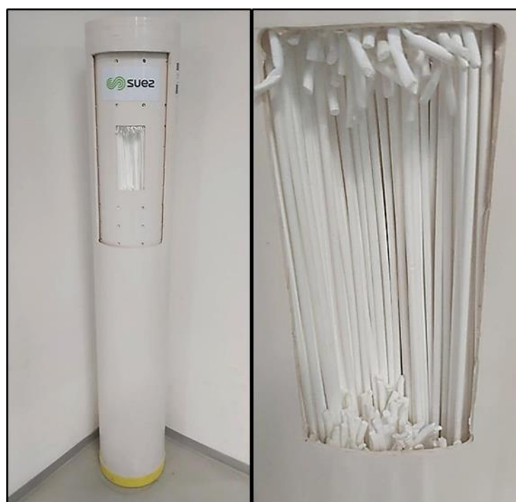
Slika 31. Membranski modul (SKID) sa 60 šupljih vlakana.
