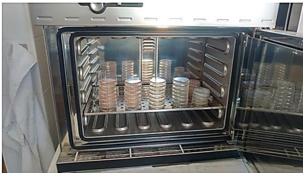
Slika 21. Termostatiranje uzoraka za određivanje koliformnih bakterija.
