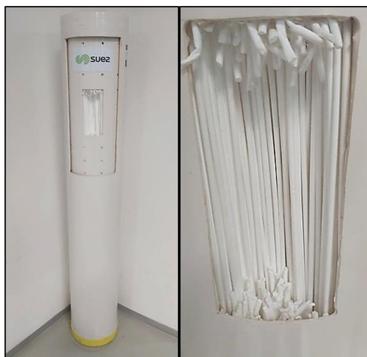
Slika 31. Membranski modul (SKID) sa 60 šupljih vlakana.
