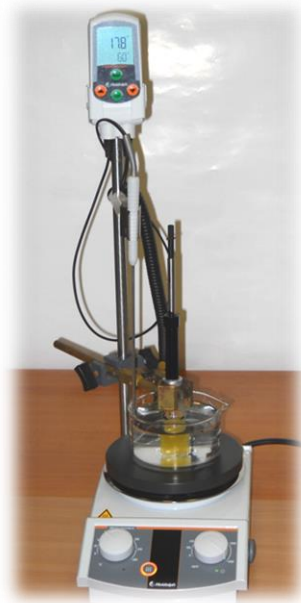
Slika 16. Aparatura za mikroekstrakciju vršnih para na krutoj fazi (HS-SPME). 38
