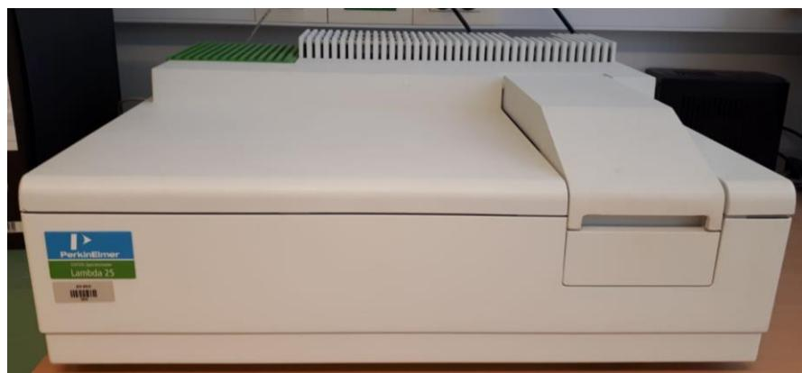
Slika 16. UV/Vis spektrofotometar Perkin Elmer Lambda 25
