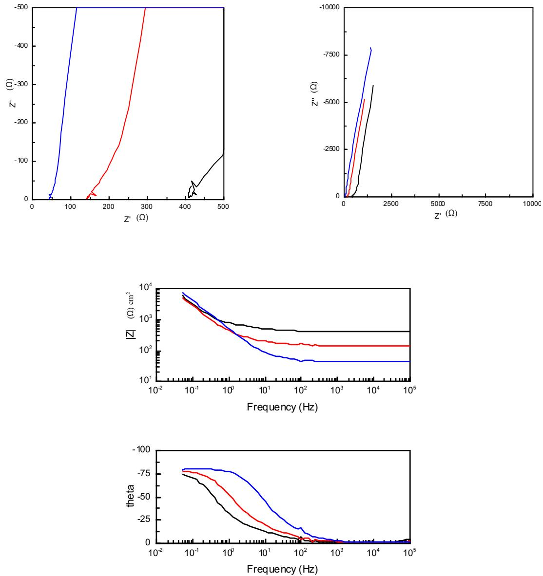
*Slika 32. Impedancijski spektri snimljeni u čistim puferima za GCE elektrodu modificiranu s MWCNT. Acetatni pufer-crna; model otopine vina-plava; Britton-Robinson pufer-crvena.*
