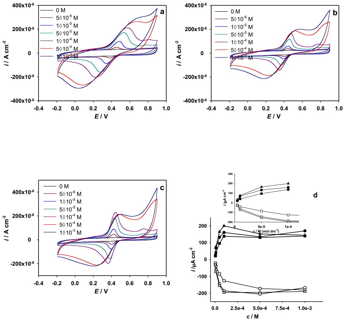
**Slika 30.** Ciklički voltamogrami snimljeni na elektrodi od staklastog ugljika, modificiranoj sa SWCNT, pri različitim koncentracijama katehina u različitim puferima: a) acetatni pufer; b) model otopine vina; c) Britton-Robinson pufer, pri pH 3,6. Posmik  $50 \text{ mV s}^{-1}$ . d) Ovisnost visine strujnog pika (iz prikazanih voltamograma) o koncentraciji katehina za različite pufore: (●) acetatni pufer; (■) model otopine vina; (▲) Britton-Robinson pufer, pri pH 3,6.
