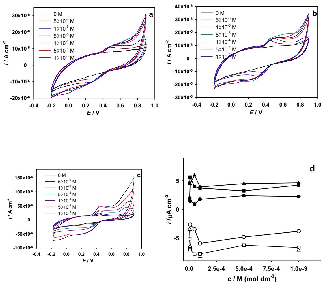
**Slika 26.** Ciklički voltamogrami snimljeni na elektrodi od staklastog ugljika, pri različitim koncentracijama katehina u različitim puferima: a) acetatni pufer; b) model otopine vina; c) Britton-Robinson pufer, pri pH 3,6. Posmik  $50 \text{ mV s}^{-1}$ . d) Ovisnost visine strujnog pika (iz prikazanih voltamograma) o koncentraciji katehina za različite puferne: (●) acetatni pufer; (■) model otopine vina; (▲) Britton-Robinson pufer pri, pH 3,6.
