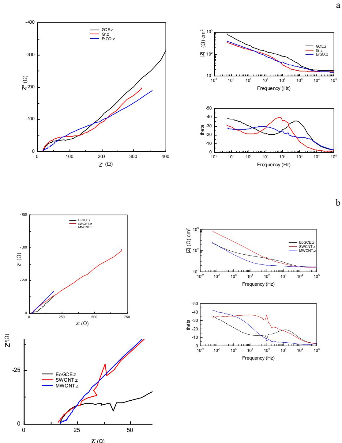
**Slika 25.** (a) Elektrokemijski impedancijski spektri snimljeni za različite elektrode u 5 mM otopini  $K_3[Fe(CN)_6]$  u 0,1 M KCl; (b) Elektrokemijski impedancijski spektri snimljeni za elektrokemijski oksidirane elektrode u 5 mM otopini  $K_3[Fe(CN)_6]$  u 0,1 M KCl.
