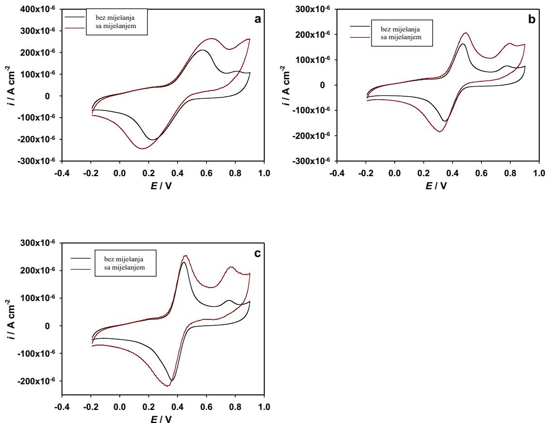
**Slika 52.** Ciklički voltamogrami snimljeni bez i uz prisilnu konvekciju, na elektrodi od staklastog ugljika modificiranoj sa SWCNT, pri koncentraciji katechina od  $1,0 \times 10^{-4} M$  u različitim puferima: (a) acetatni pufer; (b) otopina modela vina; (c) Britton-Robinson pufer, pH 3,6.
