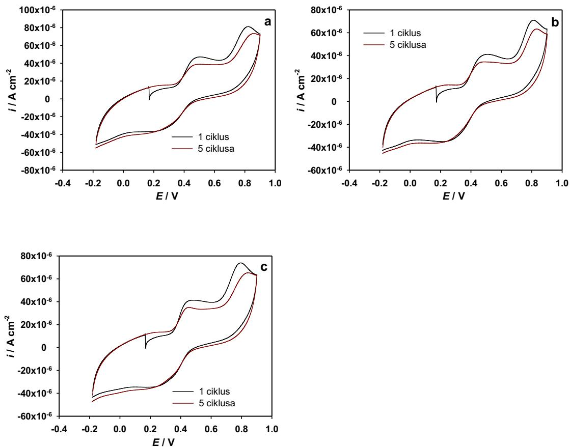
**Slika 35.** Ciklički voltamogrami snimljeni pri različitim brojem ciklusa, na elektrodi od staklastog ugljika, modificiranoj s Gr, pri koncentraciji katehina od  $1,0 \times 10^{-4} \text{ M}$  u različitim puferima: (a) acetatni pufer; (b) otopina modela vina; (c) Britton-Robinson pufer, pH 3,6.
