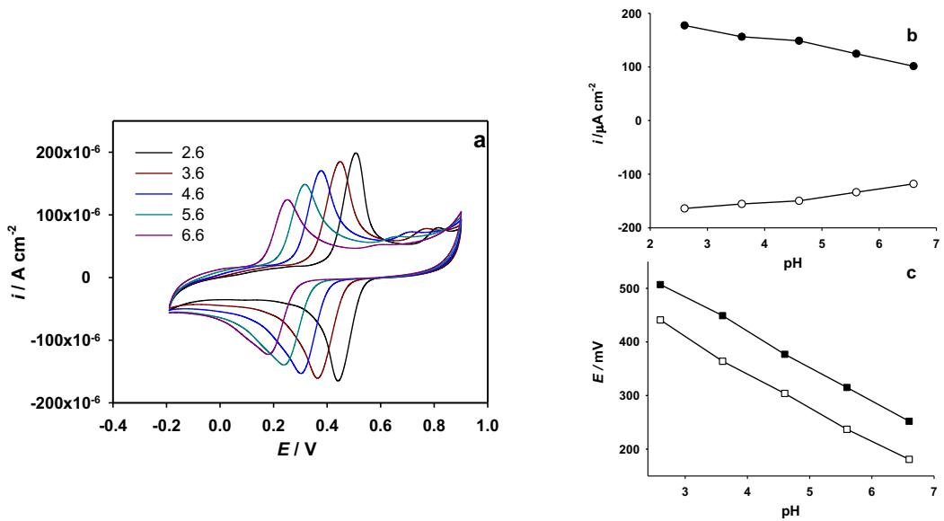
**Slika 50.** (a) Ciklički voltamogrami snimljeni na elektrodi od staklastog ugljika, modificiranoj sa SWCNT, u Britton-Robinson puferu pri različitim pH vrijednostima. Brzina posmika  $50 \text{ mV s}^{-1}$ . Koncentracija katehina od  $1,0 \times 10^{-4} \text{ M}$ ; (b) Ovisnost visine strujnog pika o pH; (c) Ovisnost potencijala strujnog pika o pH
