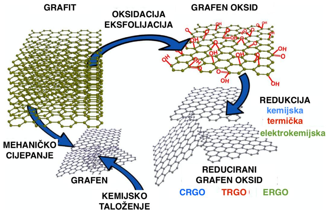
*Slika14.* Shematski prikaz dobivanja grafena i reduciranih grafenovih oksida<sup>[19]</sup>
