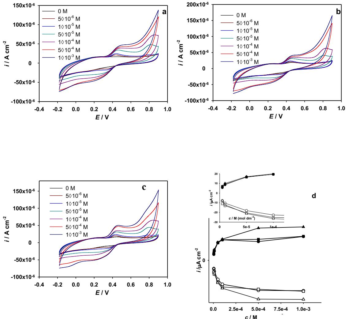
**Slika 27.** Ciklički voltamogrami snimljeni na elektrodi od staklastog ugljika, modificiranoj sa Gr, pri različitim koncentracijama katehina u različitim puferima: a) acetatni pufer; b) model otopine vina; c) Britton-Robinson pufer pri, pH 3,6. Posmik 50 mV s<sup>-1</sup>. d) Ovisnost visine strujnog pika (iz prikazanih voltamograma) o koncentraciji katehina za različite pufera: (●) acetatni pufer; (■) model otopine vina; (▲) Britton-Robinson pufer pri, pH 3,6.
