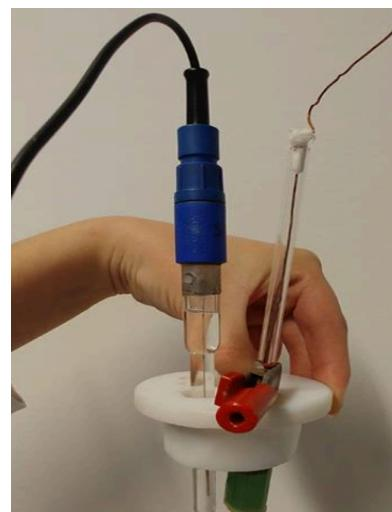
*Slika 19. Referentna i protuelektroda*
