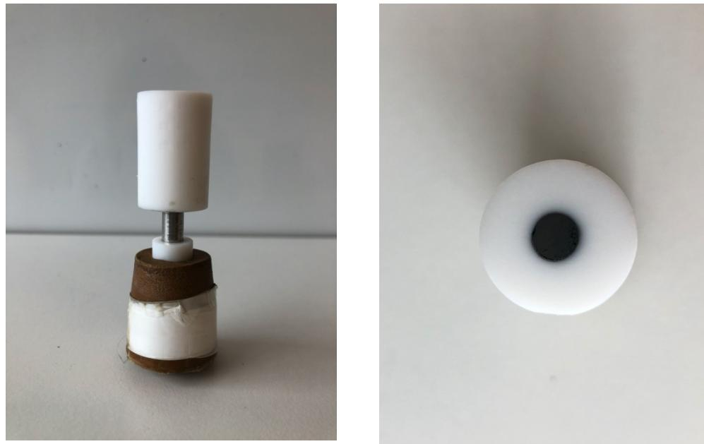
*Slika 18. Radna elektroda*
