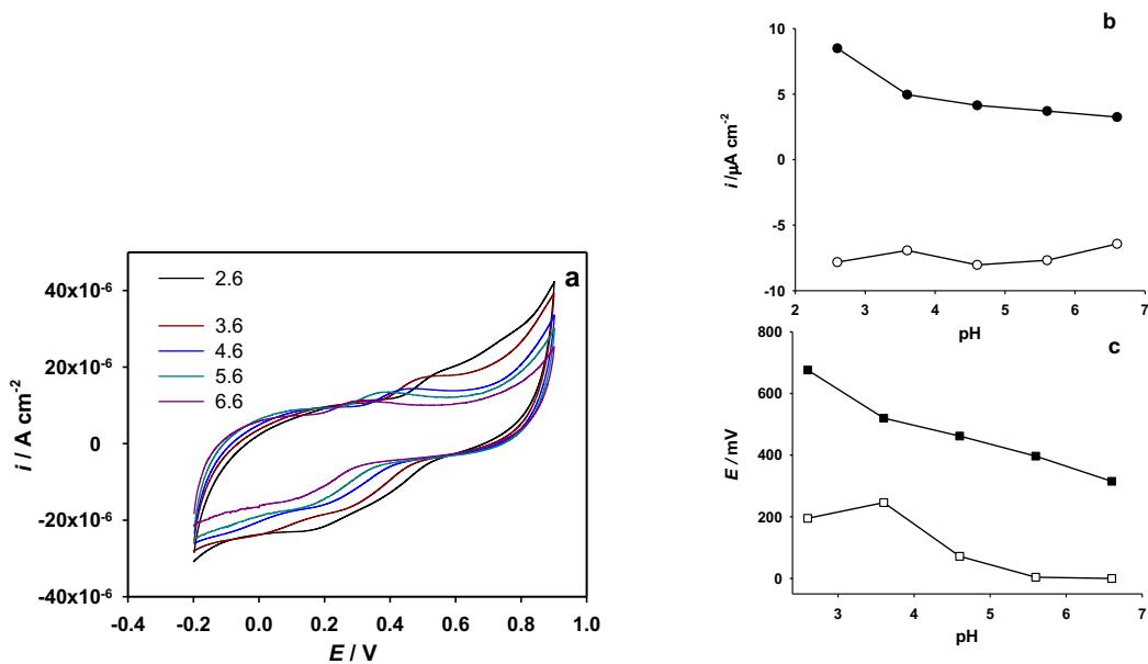
**Slika 46.** (a) Ciklički voltamogrami snimljeni na elektrodi od staklastog ugljika u Britton-Robinson puferu pri različitim pH vrijednostima. Brzina posmika  $50 \text{ mV s}^{-1}$ . Koncentracija katehina od  $1,0 \times 10^{-4} \text{ M}$ ; (b) Ovisnost visine strujnog pika o pH; (c) Ovisnost potencijala strujnog pika o pH.
