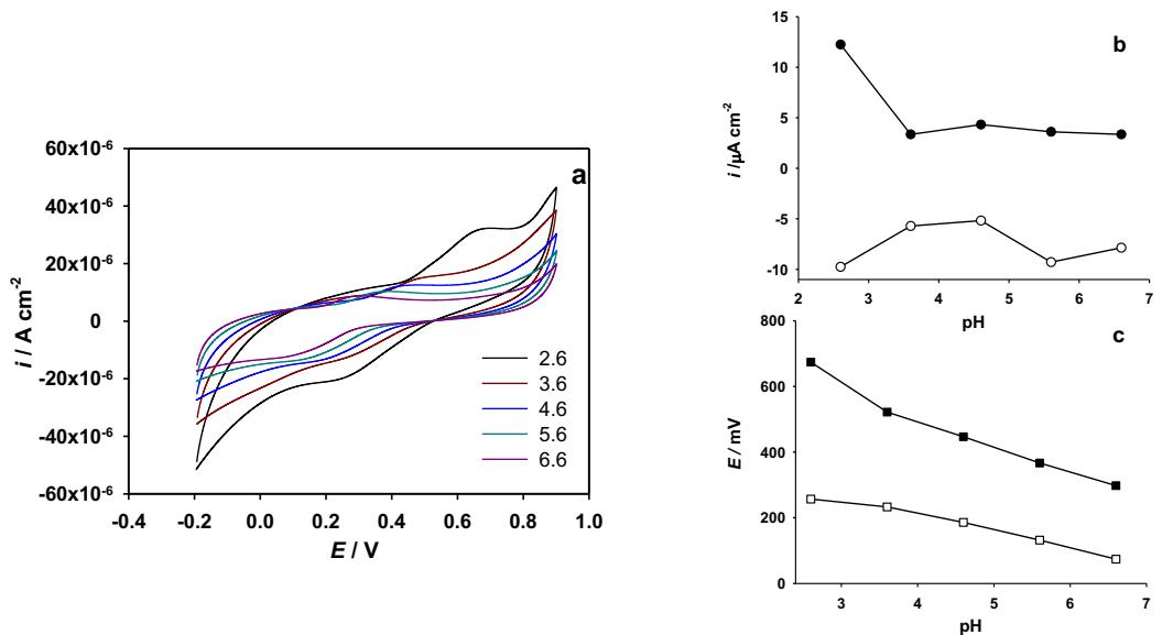
**Slika 49.** (a) Ciklički voltamogrami snimljeni na elektrokemijski pripremljenoj elektrodi od staklastog ugljika u Britton-Robinson puferu pri različitim pH vrijednostima. Brzina posmika  $50 \text{ mV s}^{-1}$ . Koncentracija katehina od  $1,0 \times 10^{-4} \text{ M}$ ; (b) Ovisnost visine strujnog pika o pH; (c) Ovisnost potencijala strujnog pika o pH
