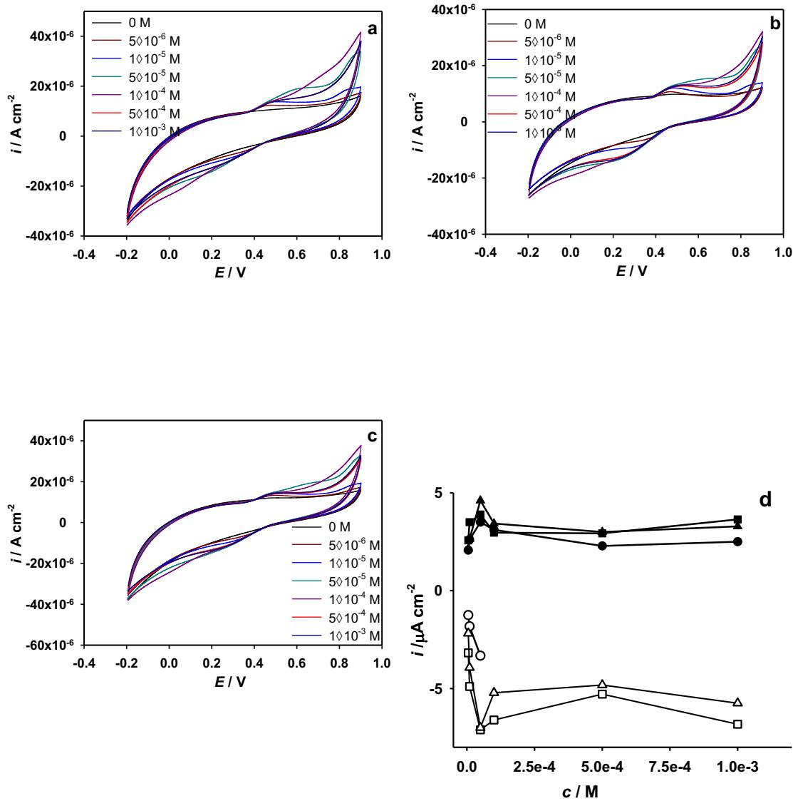
**Slika 29.** Ciklički voltamogrami snimljeni na elektrokemijski pripremljenoj elektrodi od staklastog ugljika, pri različitim koncentracijama katehina u različitim puferima: a) acetatni pufer; b) model otopine vina; c) Britton-Robinson pufer, pri pH 3,6. Posmik  $50 \text{ mV s}^{-1}$ . d) Ovisnost visine strujnog pika (iz prikazanih voltamograma) o koncentraciji katehina za različite pufere: (●) acetatni pufer; (■) model otopine vina; (▲) Britton-Robinson pufer pri pH 3,6.
