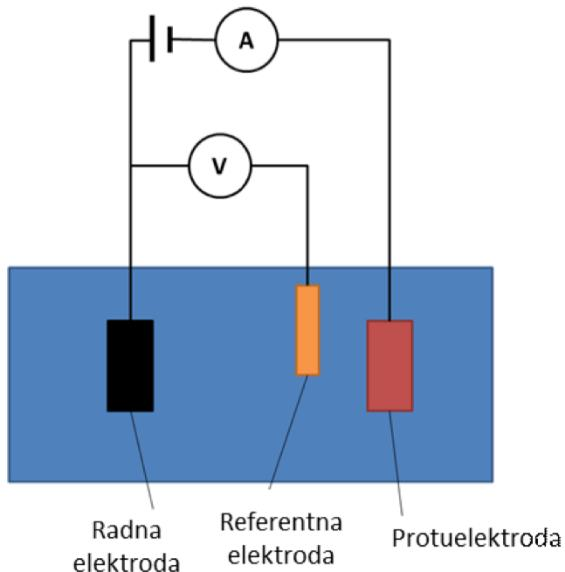
*Slika 5. Elektrokemijska čelija za voltametrijska mjerena<sup>[14]</sup>*
