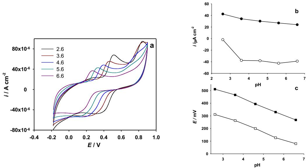
**Slika 47.** (a) Ciklički voltamogrami snimljeni na elektrodi od staklastog ugljika, modificiranoj s Gr, u Britton-Robinson puferu pri različitim pH vrijednostima. Brzina posmika  $50 \text{ mV s}^{-1}$ . Koncentracija katehina od  $1,0 \times 10^{-4} \text{ M}$ ; (b) Ovisnost visine strujnog pika o pH; (c) Ovisnost potencijala strujnog pika o pH.
