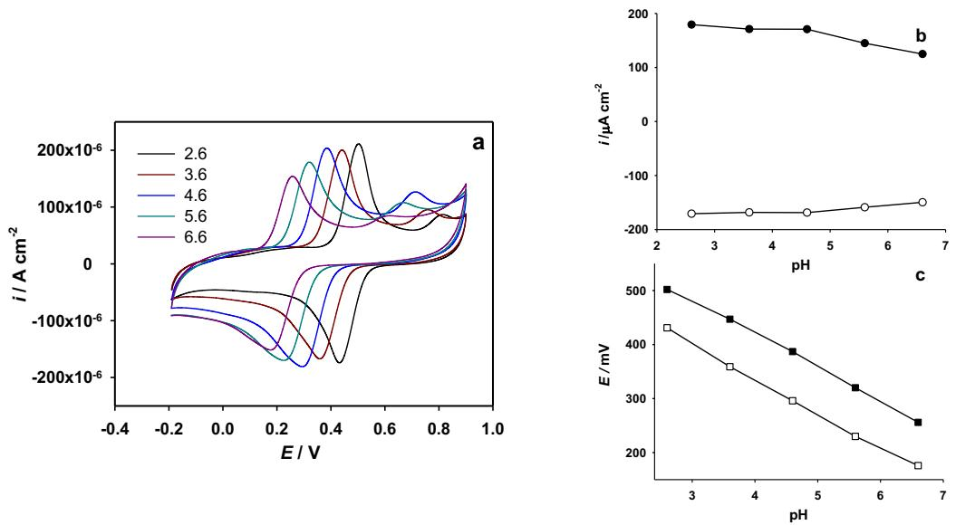
*Slika 51.* (a) Ciklički voltamogrami snimljeni na elektrodi od staklastog ugljika, modificiranoj s MWCNT, u Britton-Robinson puferu pri različitim pH vrijednostima. Brzina posmika  $50 \text{ mV s}^{-1}$ . Koncentracija katehina od  $1,0 \times 10^{-4} \text{ M}$ ; (b) Ovisnost visine strujnog pika o pH; (c) Ovisnost potencijala strujnog pika o pH
