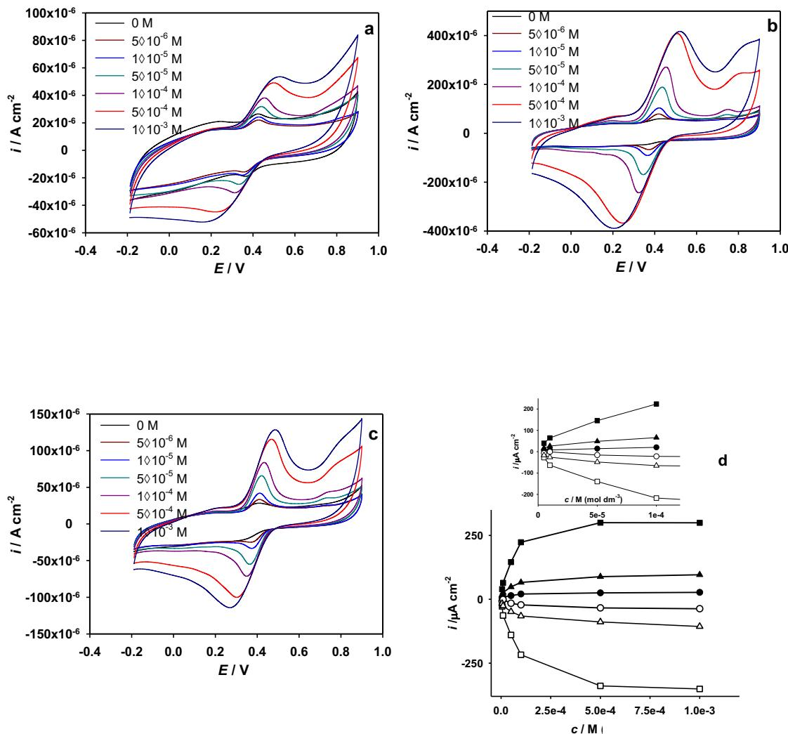
**Slika 28.** Ciklički voltamogrami snimljeni na elektrodi od staklastog ugljika, modificiranoj s ErGO, pri različitim koncentracijama katehina u različitim puferima: a) acetatni pufer; b) model otopine vina; c) Britton-Robinson pufer, pri pH 3,6. Posmik 50 mV s<sup>-1</sup>. d) Ovisnost visine strujnog pika (iz prikazanih voltamograma) o koncentraciji katehina za različite pufore: (●) acetatni pufer; (■) model otopine vina; (▲) Britton-Robinson pufer, pri pH 3,6.
