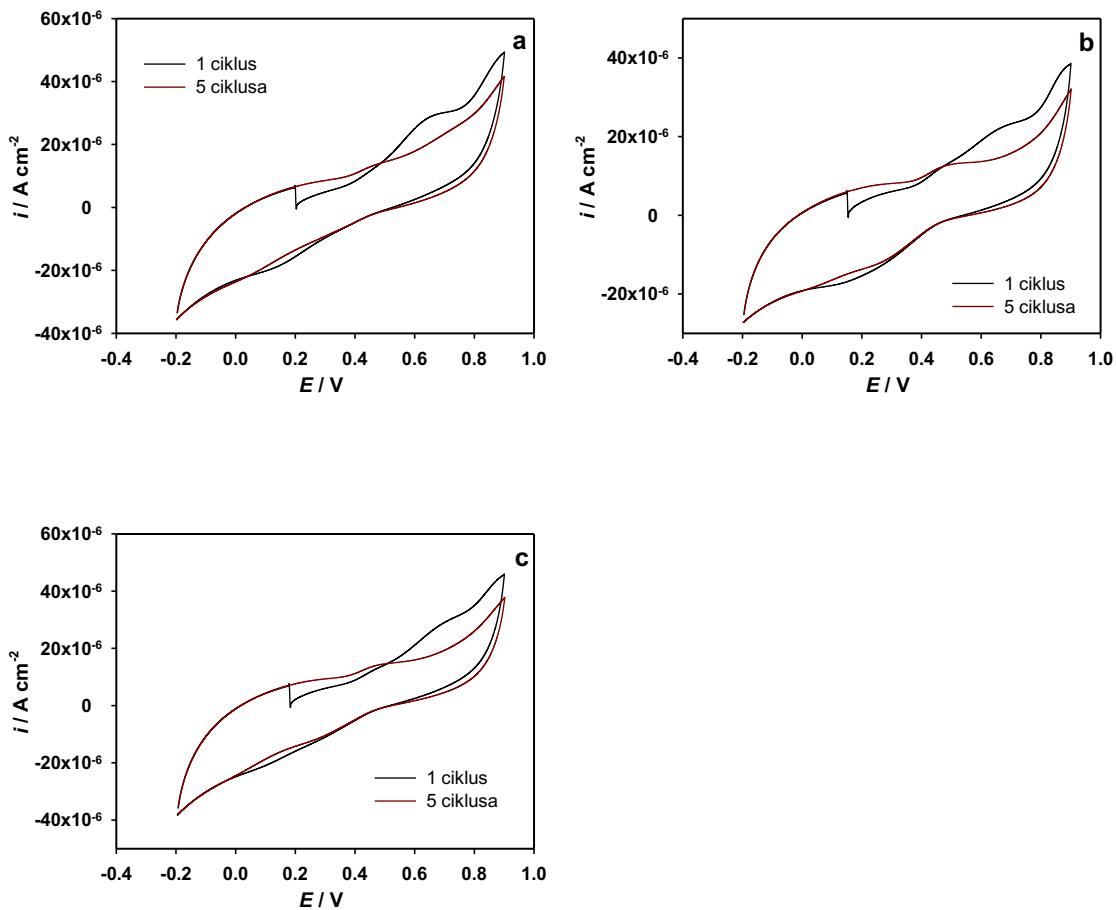
*Slika 37.* Ciklički voltamogrami snimljeni pri različitim brojem ciklusa, na elektrokemijski pripremljenoj elektrodi od staklastog ugljika, pri koncentraciji katehina od  $1,0 \times 10^{-4} \text{ M}$  u različitim puferima: (a) acetatni pufer; (b) otopina modela vina; (c) Britton-Robinson pufer, pH 3,6.
