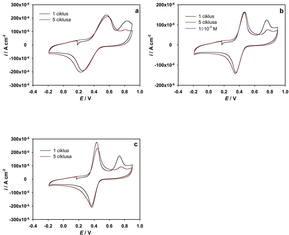
*Slika 38.* Ciklički voltamografi snimljeni pri različitim brojem ciklusa, na elektrodi od staklastog ugljika, modificiranoj sa SWCNT, pri koncentraciji katehina od  $1,0 \times 10^{-4} \text{ M}$  u različitim puferima: (a) acetatni pufer; (b) otopina modela vina; (c) Britton-Robinson pufer, pH 3,6.
