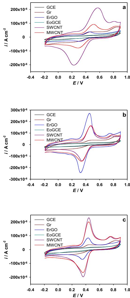
**Slika 60.** Ciklički voltamogrami snimljeni pri koncentraciji katehina od  $1,0 \times 10^{-4} \text{ M}$  na različitim elektrodomama i u različitim puferima ( $\text{pH } 3,6; 0,1 \text{ M}$ ): (a) acetatni pufer; (b) model otopine vina; (c) Britton-Robinson pufer
