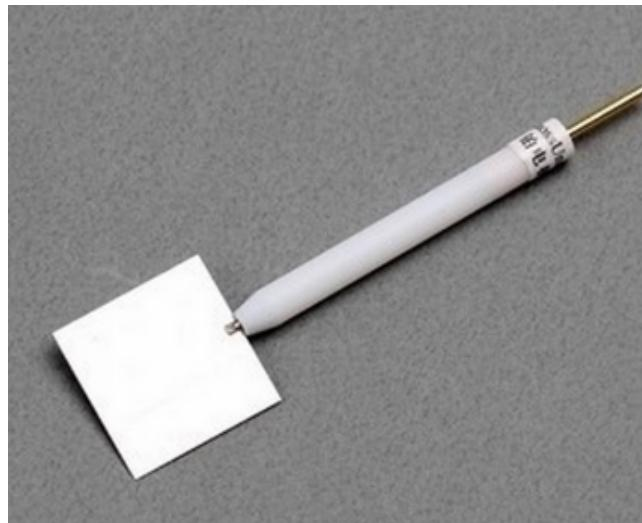
*Slika 9. Platinska pločica – protuelektroda<sup>[18]</sup>*
