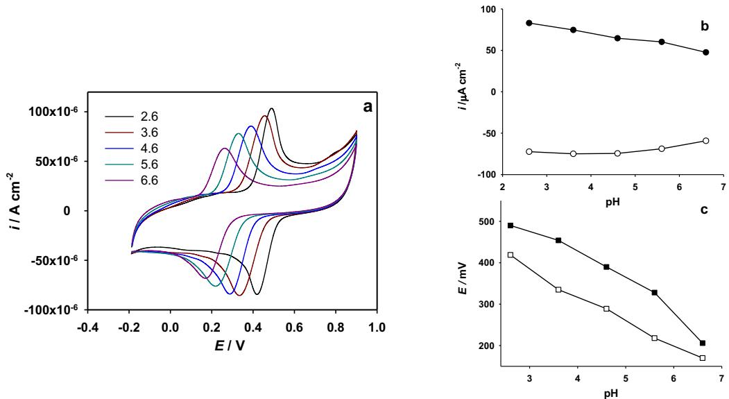
**Slika 48.** (a) Ciklički voltamogrami snimljeni na elektrodi od staklastog ugljika, modificiranoj s ErGO, u Britton-Robinson puferu pri različitim pH vrijednostima. Brzina posmika  $50 \text{ mV s}^{-1}$ . Koncentracija katehina od  $1,0 \times 10^{-4} \text{ M}$ ; (b) Ovisnost visine strujnog pika o pH; (c) Ovisnost potencijala strujnog pika o pH.
