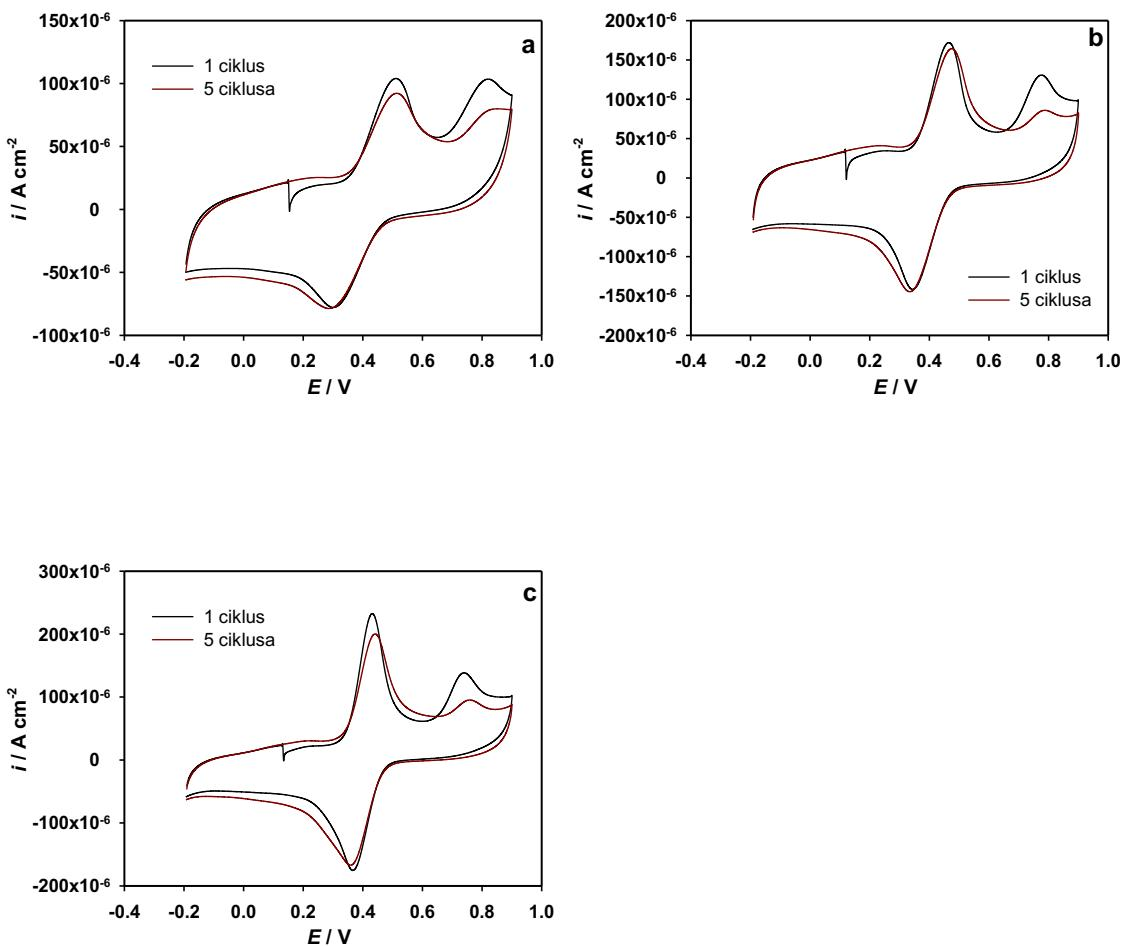
**Slika 39.** Ciklički voltamogrami snimljeni pri različitim brojem ciklusa, na elektrodi od staklastog ugljika, modificiranoj s MWCNT, pri koncentraciji katehina od  $1,0 \times 10^{-4} \text{ M}$  u različitim puferima: (a) acetatni pufer; (b) otopina modela vina; (c) Britton-Robinson pufer, pH 3,6.
