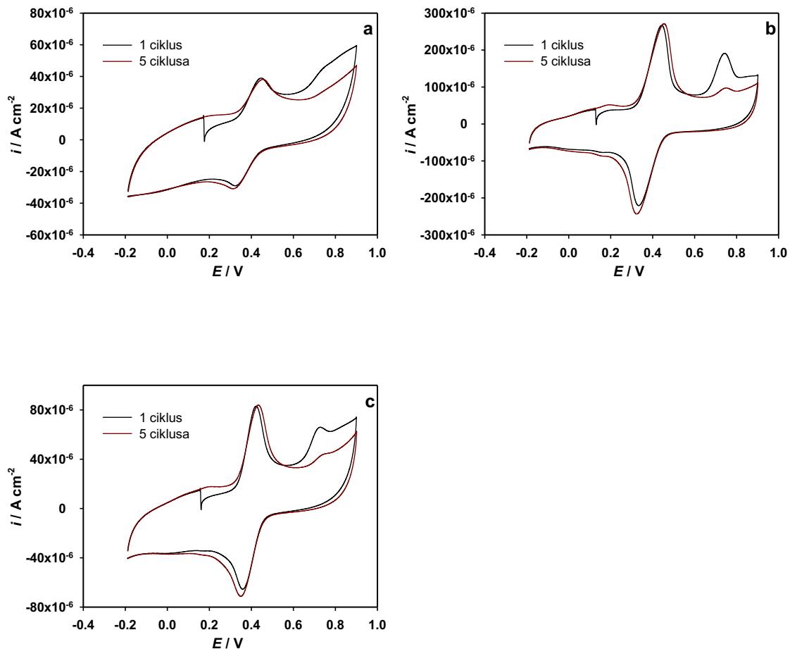
*Slika 36.* Ciklički voltamogrami snimljeni pri različitim brojem ciklusa, na elektrodi od staklastog ugljika, modificiranoj s ErGO, pri koncentraciji katechina od  $1,0 \times 10^{-4} \text{ M}$  u različitim puferima: (a) acetatni pufer; (b) otopina modela vina; (c) Britton-Robinson pufer, pH 3,6.
