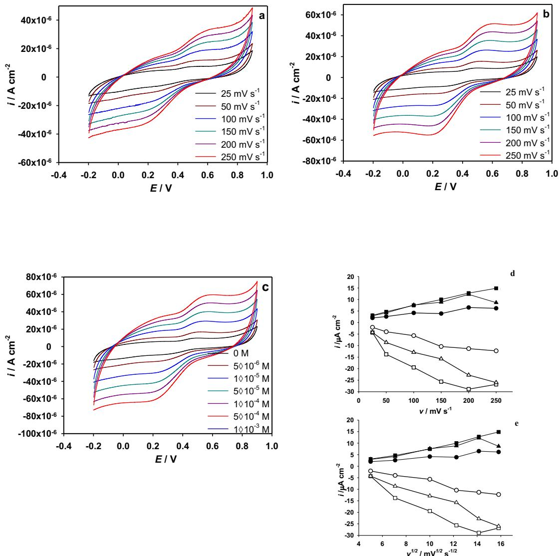
**Slika 54.** Ciklički voltamogrami snimljeni na elektrodi od staklastog ugljika pri različitoj brzini posmika. Koncentracija katehina od  $1,0 \times 10^{-4} \text{ M}$  u različitim puferima: a) acetatni pufer; b) model otopine vina; c) Britton-Robinson pufer, pri pH 3,6. Ovisnost visine anodnog strujnog pika (iz prikazanih voltamograma) o brzini posmika (d) i njegovom korijenu (e) u različitim puferima: (●) acetatni pufer; (■) model otopine vina; (▲) Britton-Robinson pufer, pri pH 3,6.
