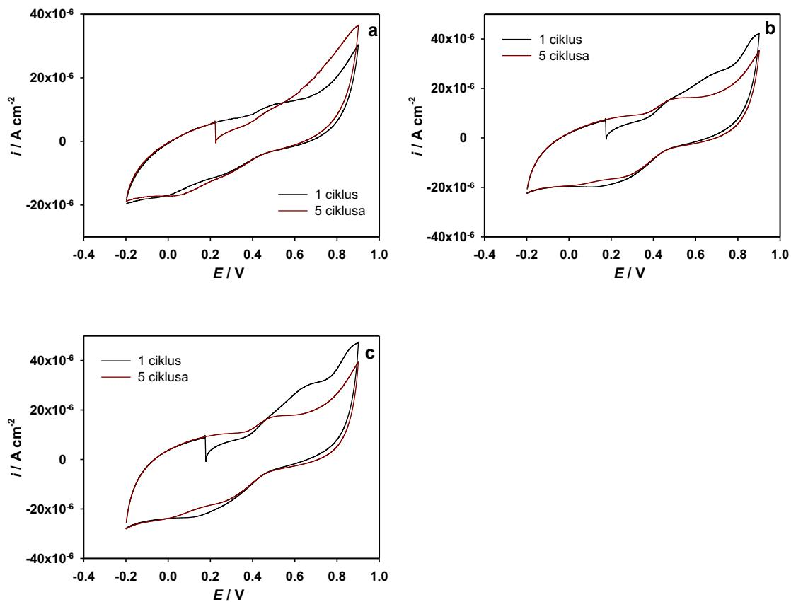
**Slika 34.** Ciklički voltamogrami snimljeni pri različitim brojem ciklusa, na elektrodi od staklastog ugljika pri koncentraciji katehina od  $1,0 \times 10^{-4} \text{ M}$  u različitim puferima: (a) acetatni pufer; (b) otopina modela vina; (c) Britton-Robinson pufer, pri pH 3,6.
