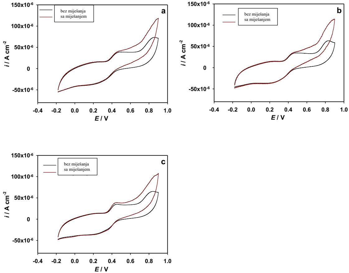
**Slika 53.** Ciklički voltamogrami snimljeni bez i uz prisilnu konvekciju, na elektrodi od staklastog ugljika modificiranoj s Gr, pri koncentraciji katechina od  $1,0 \times 10^{-4} \text{ M}$  u različitim puferima: (a) acetatni pufer; (b) otopina modela vina; (c) Britton-Robinson pufer, pH 3,6.
