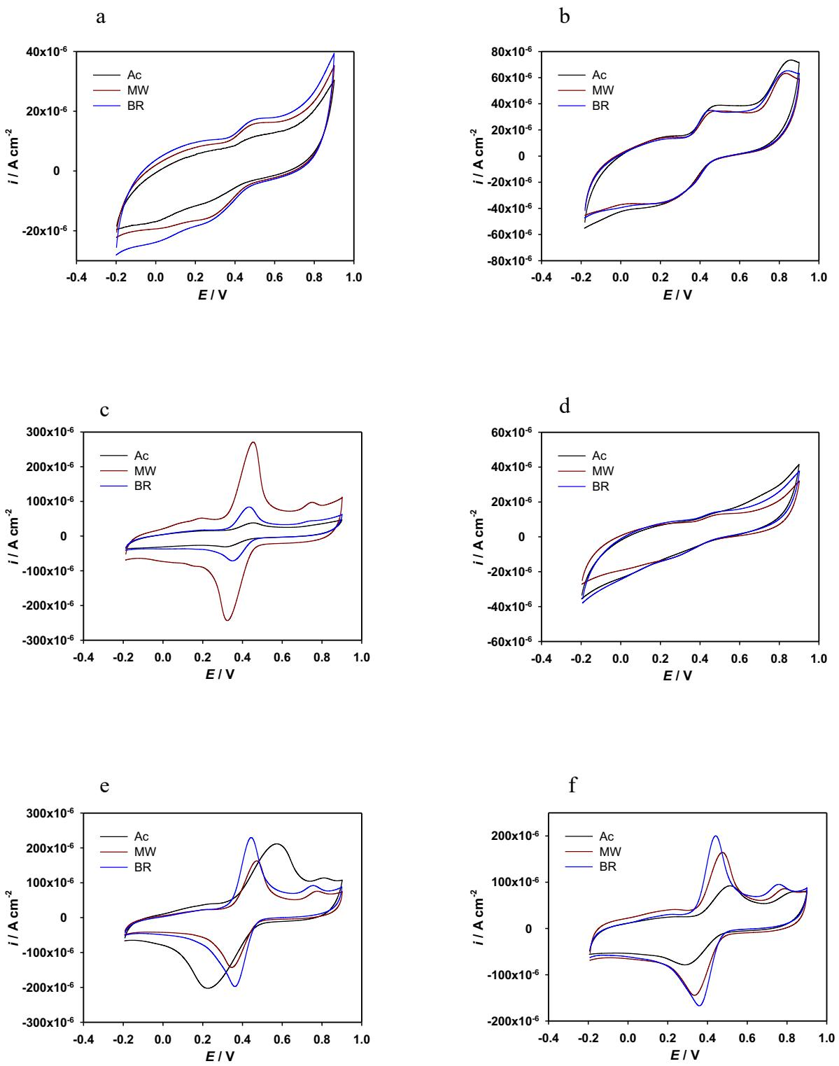
**Slika 61.** Ciklički voltamogrami snimljeni pri koncentraciji katehina od  $1,0 \times 10^{-4} \text{ M}$  u različitim puferima, na različitim elektrodoma: (a) GCE; (b) Gr; (c) ErGO; (d) EoGCE;; (f) SWCNT; (e) MWCNT.
