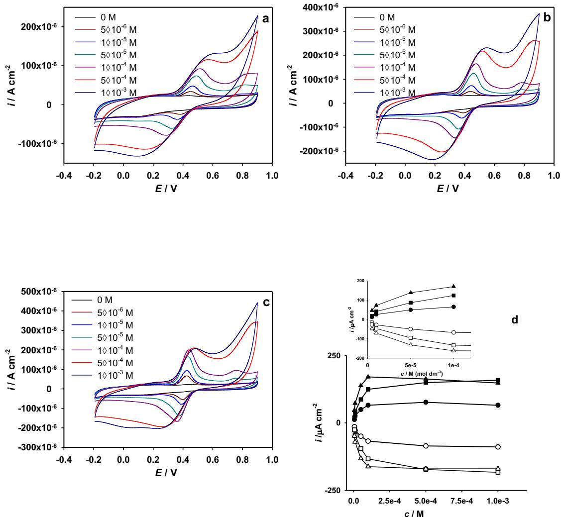
*Slika 31.* Ciklički voltamogrami snimljeni na elektrodi od staklastog ugljika, modificiranoj s MWCNT, pri različitim koncentracijama katehina u različitim puferima: a) acetatni pufer; b) model otopine vina; c) Britton-Robinson pufer, pri pH 3,6. Posmik  $50 \text{ mV s}^{-1}$ . d) Ovisnost visine strujnog pika (iz prikazanih voltamograma) o koncentraciji katehina za različite pufere: (●) acetatni pufer; (■) model otopine vina; (▲) Britton-Robinson pufer, pri pH 3,6.
