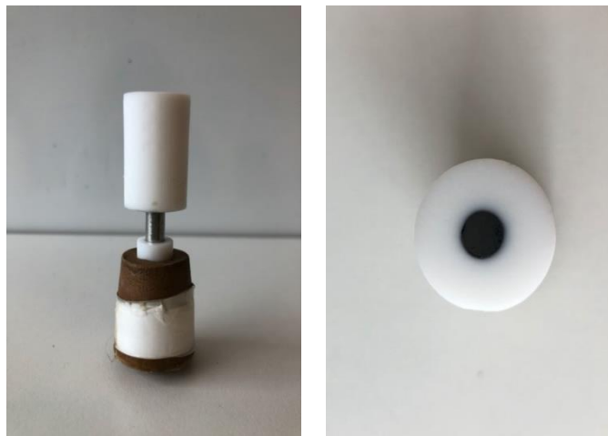
Slika 14. Radna elektroda od staklastog ugljika uklopljena u bazu načinjenu od teflona.
