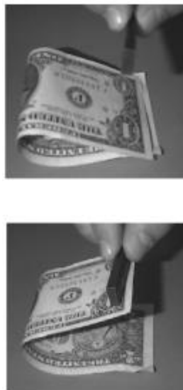
Slika 20. Magnetske tinte tiskaju se na novac u identifikacijske svrhe. Kada se snažni magnet prinese novčanici, novčanica se privuče na magnet. 1
