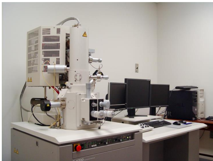
Slika 8. Hitachi S4700 FE-SEM. 16
