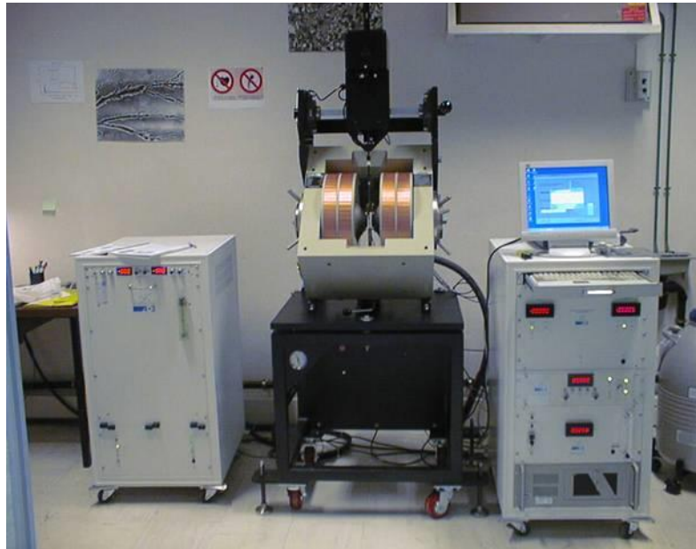
Slika 12. Magnetometar vibrirajućeg uzorka. 20
