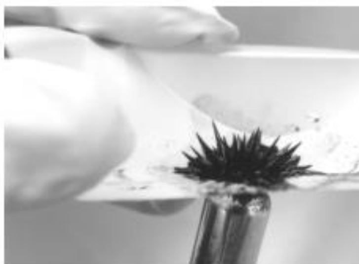
Slika 3. Bočni prikaz stvaranja bodlji ferrofluida u prisutnosti snažnog magneta postavljenog ispod lađice. 1
