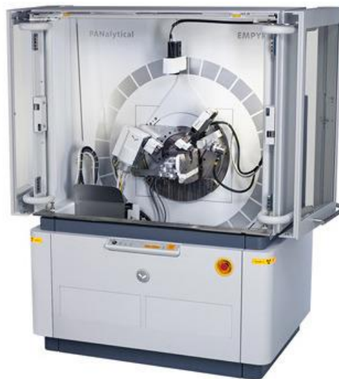
Slika 11. Empyrean difraktometar X-zraka. 19
