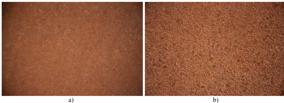
Slika 22. Površina Cu elektrode nakon potenciodinamičkog polarizacijskog mjerenja u 0,5 mol dm -3 NaCl otopini uz uvećanje a) 100× i b) 200×
