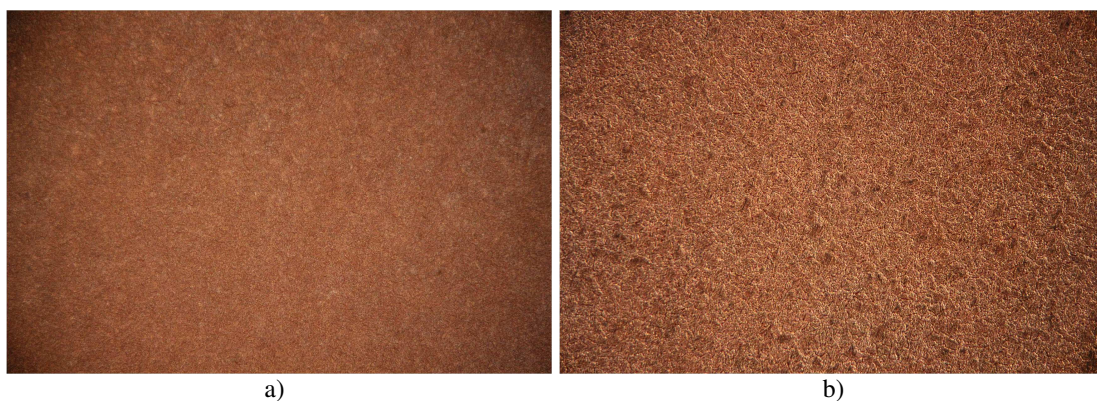
Slika 22. Površina Cu elektrode nakon potenciodinamičkog polarizacijskog mjerenja u 0,5 \text{ mol dm}^{-3} NaCl otopini uz uvećanje a) 100\times i b) 200\times
