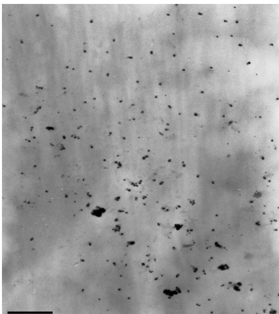
Slika 24. TEM snimka za dobivene koloide srebra u uzorku E3 (povećanje 16000X)
