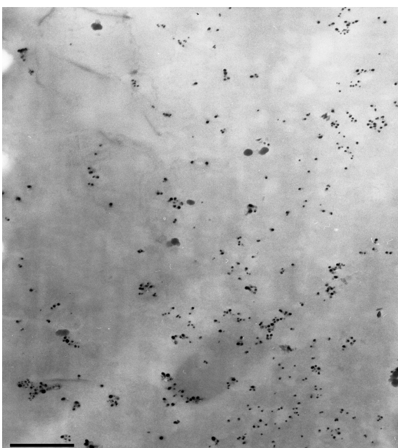
Slika 23. TEM snimka za dobivene koloide srebra u uzorku E2 (povećanje 16000X)
