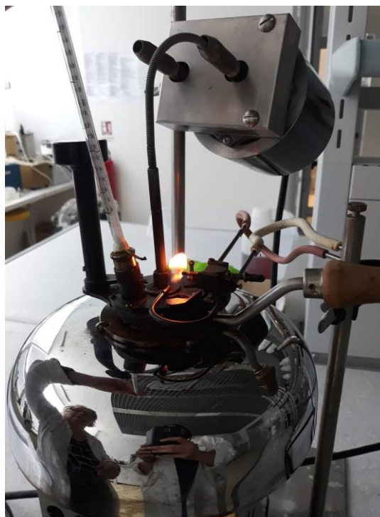
Slika 10. Uređaj za određivanje plamišta po Pensky- Martensu
