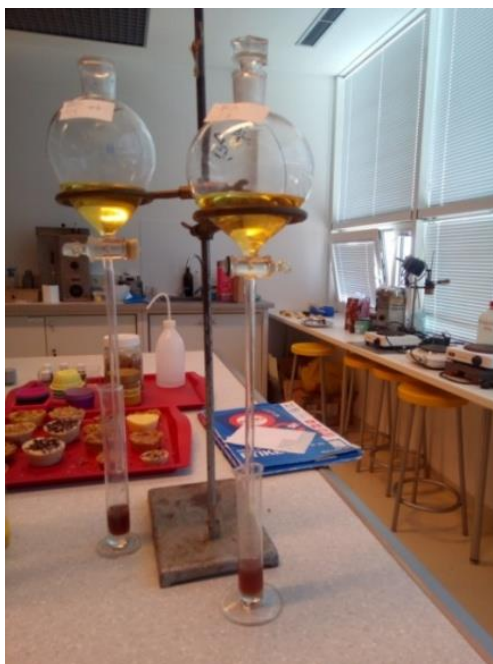
Slika 8. Odvajanje glicerola od biodizela
