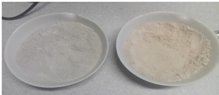
Slika 9. Zeolit klinoptilolit veličine čestica  $10\mu\text{m}$  (lijevo) i  $50\mu\text{m}$  (desno)
