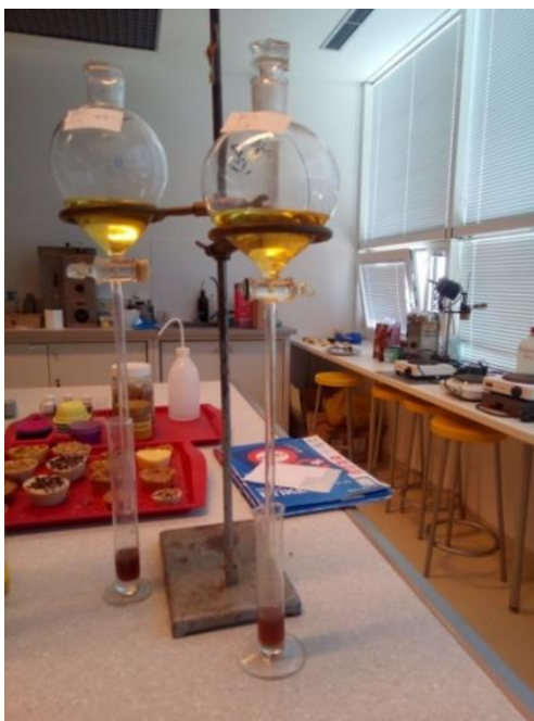
Slika 8. Odvajanje glicerola od biodizela
