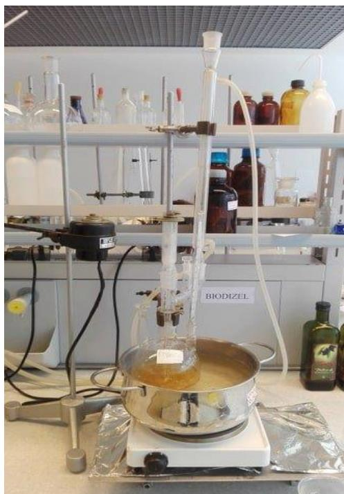
Slika 7. Aparatura za provedbu procesa transesterifikacije biljnog ulja
