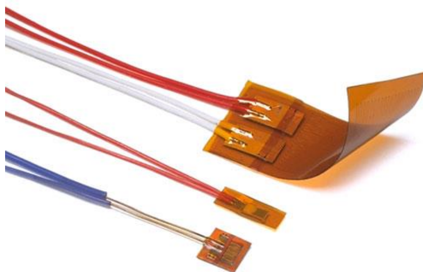
Slika 42. Primjer površinskih sonde za mjerenje temperature stijenke šaržnog reaktora 33
