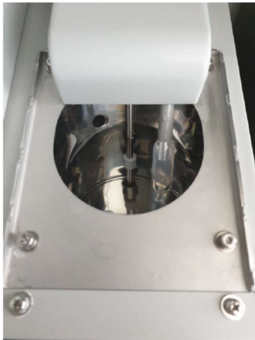
Slika 17. Prikaz spremnika uređaja Horiba LA-300 32 .
