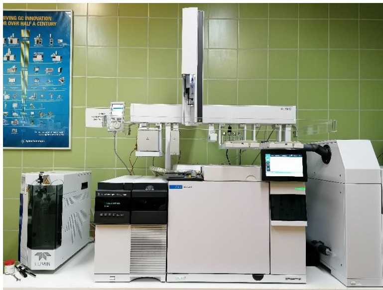
Slika 34. Vezani sustav plinska kromatografija-spektrometrija masa (GC-MS)
