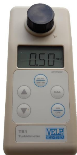
Slika 2.3. Turbidimetar Velp Scientifica.
