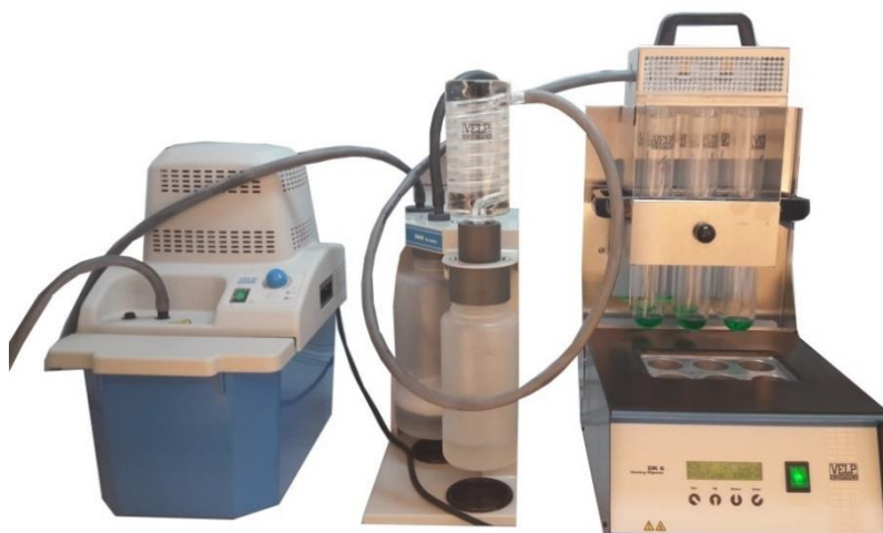
Slika 2.5. Uređaj za digestiju uzorka.
