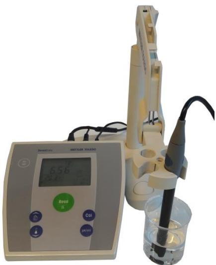
**Slika 2.1.** pH-metar Mettler Toledo.
