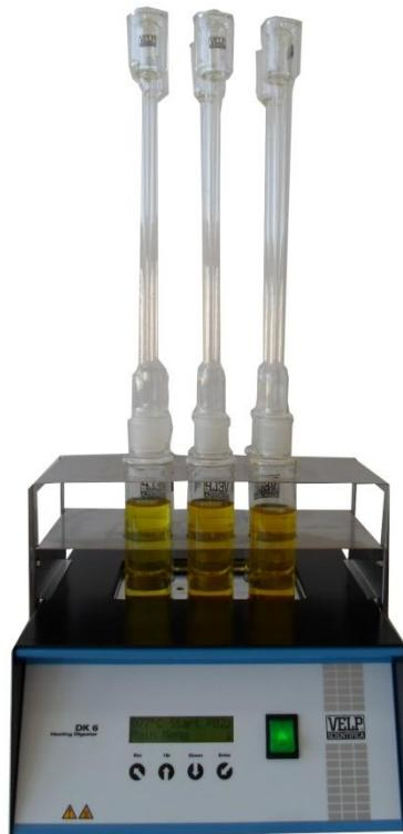
**Slika 2.4.** Uređaj za određivanje KPK bikromatnom metodom.
