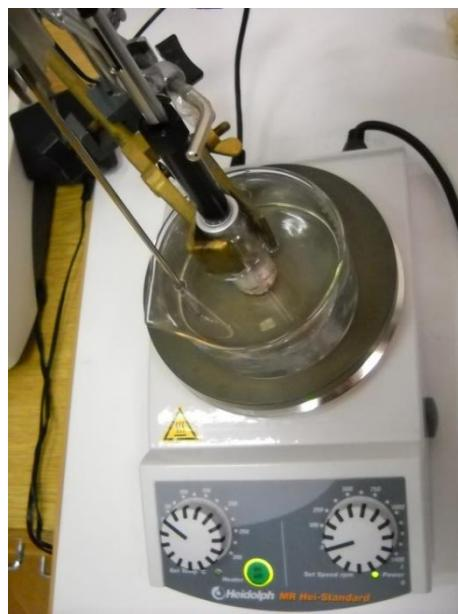
*Slika 7.* Aparatura za pripremu uzorka za HS-SPME<sup>32</sup>
