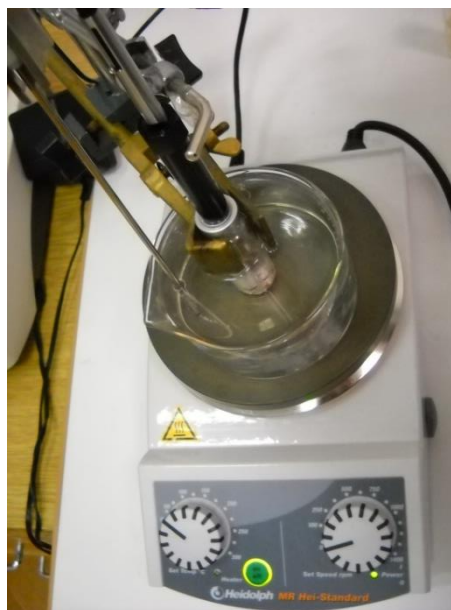
Slika 7. Aparatura za pripremu uzoraka za HS-SPME 32
