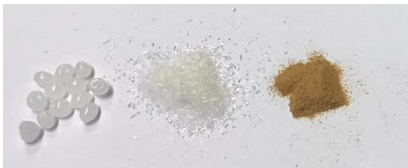
Slika 15. Granule PLA, usitnjeni PLA i mMKM
