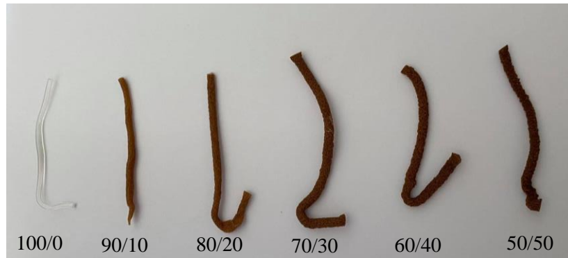
Slika 17. Ekstrudirani kompoziti PLA/mMKM
