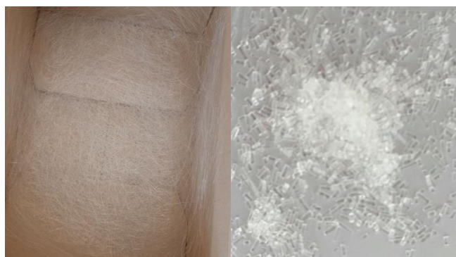
Slika 16. Ekstrudirane i usitnjene niti PLA
