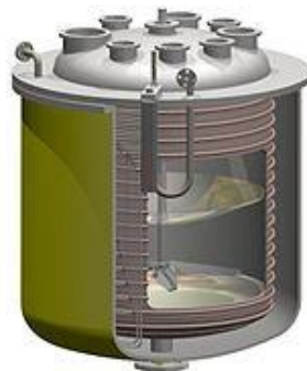
Slika 7. Šaržni reaktor s plaštom s konstantnim protokom 10
