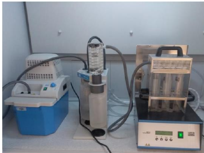
Slika 2.4. Uređaj za digestiju uzorka
