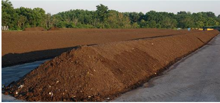
Slika 1.8. Windrow sustav kompostiranja [22]
