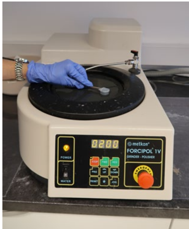
Slika 2.4. Priprema radne površine Al elektroda na uređaju za brušenje i poliranje Metkon Forcipol 1V.
