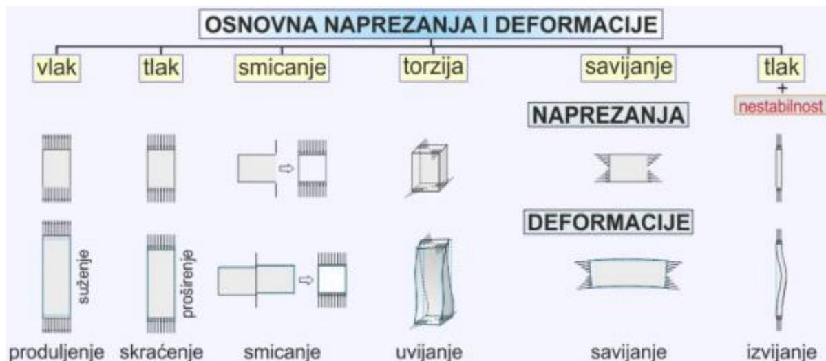
Slika 7. Vrste deformacija i naprezanja<sup>13</sup>
