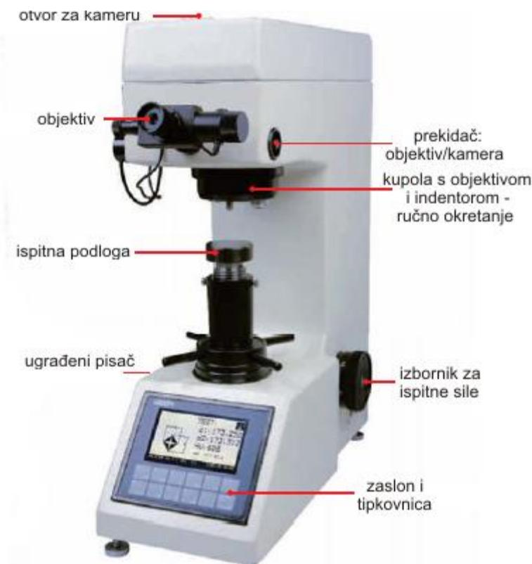
**Slika 11.** Uredaj za ispitivanje tvrdoće tzv. tvdromjer<sup>16</sup>
