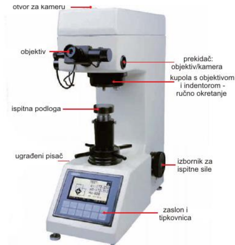
Slika 11. Uređaj za ispitivanje tvrdoće tzv. tvrdomjer 16
