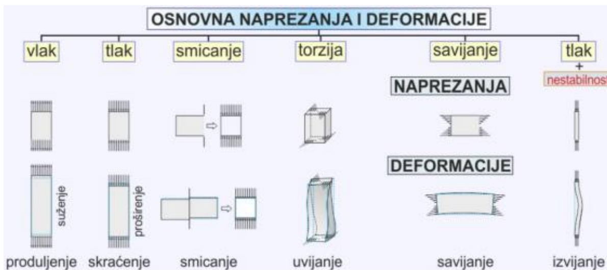
Slika 7. Vrste deformacija i naprezanja 13
