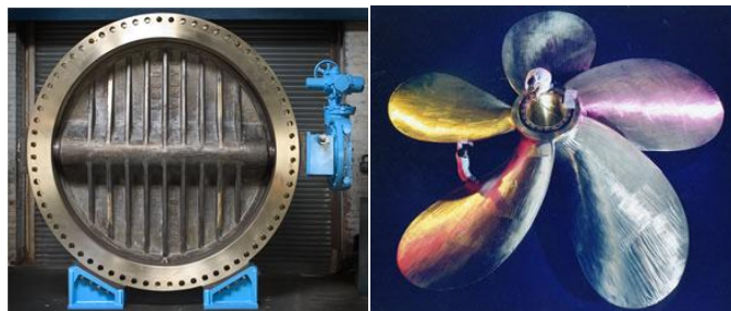
Slika 2. Primjena aluminijskih bronci: ventil (lijevo) i propeler (desno) (17)
