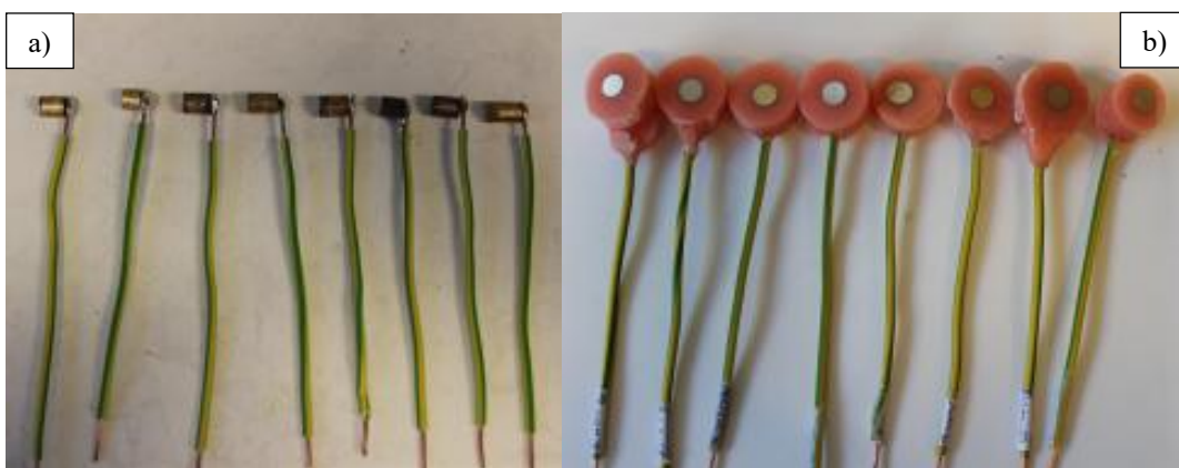
Slika 13. Izrada elektroda za elektrokemijska mjerenja
