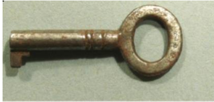
Slika 4. Korozija ključa izazvana električnom mikrobiološkom korozijom. 9
