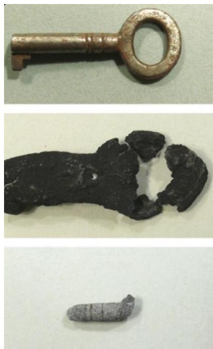
*Slika 4. Korozija ključa izazvana električnom mikrobiološkom korozijom.<sup>9</sup>*
