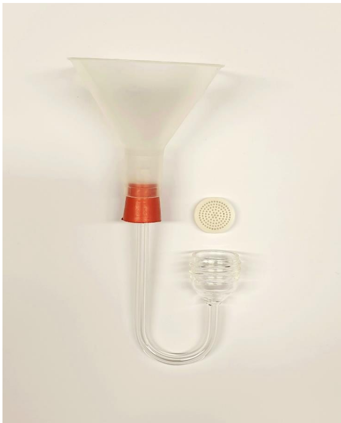
Slika 11. Difuzijska ćelija i pločica s kapilarnim otvorima.
