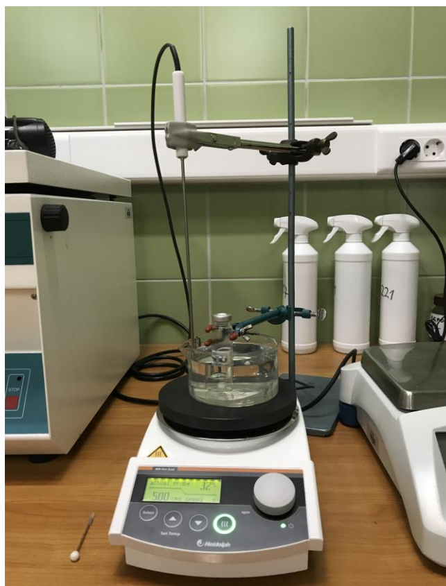
Slika 18. Kondicioniranje uzorka: vialica s uzorkom u vodenoj kupelji postavljenoj na magnetskoj miješalici
