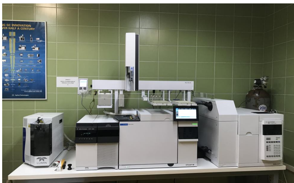
Slika 19. Vezani sustav plinska kromatografija-spektrometrija masa
