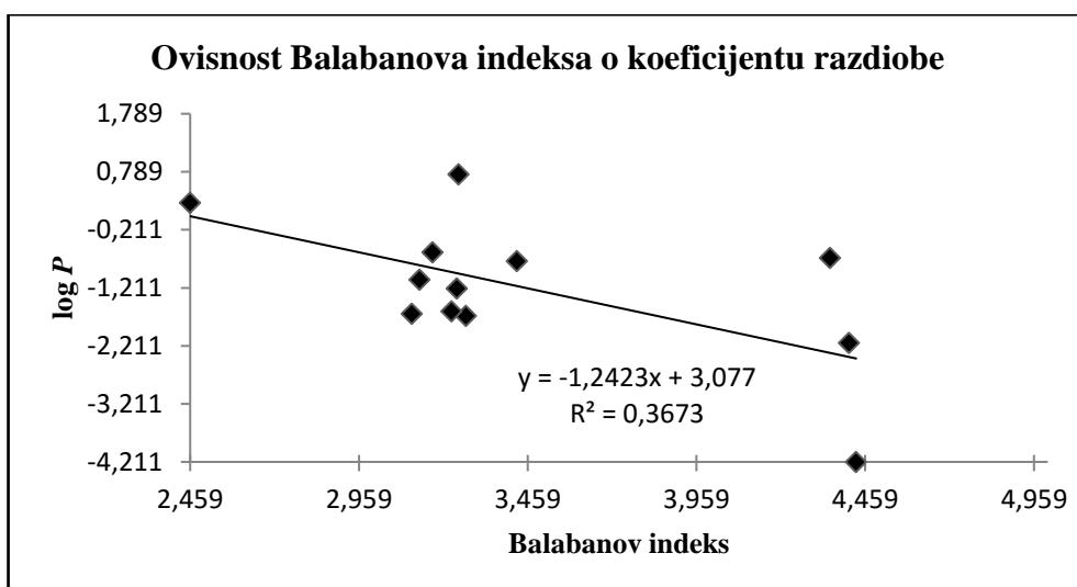
Slika 12. Linearni QSPR model za  $\log P$  ispitivanih sulfonamida temljen na vrijednosti Balabanova indeks
