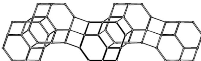
Slika 9. Struktura zeolita NaX 7
