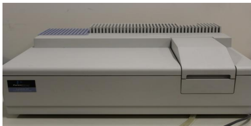
Slika 18. UV/VIS spektrofotometar PERKIN ELMER LAMBADA 25
