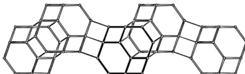
Slika 9. Struktura zeolita NaX 7
