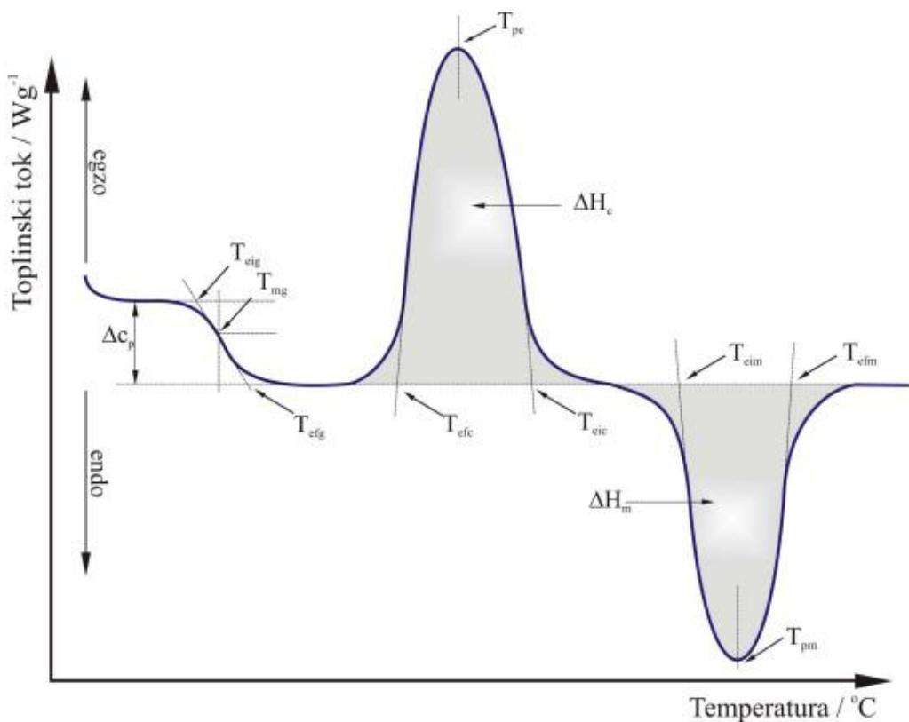
**Slika 15.** Opći prikaz DSC termograma i podataka koji se iz njega mogu odrediti<sup>25</sup>
