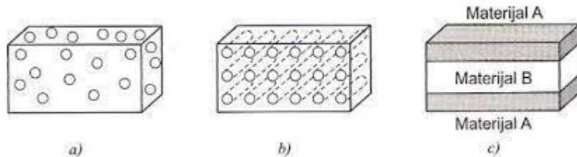
**Slika 4.** Podjela kompozita prema obliku ojačala: a) kompozit ojačan česticama, b) kompozit ojačan vlaknima, c) strukturni kompoziti<sup>2</sup>
