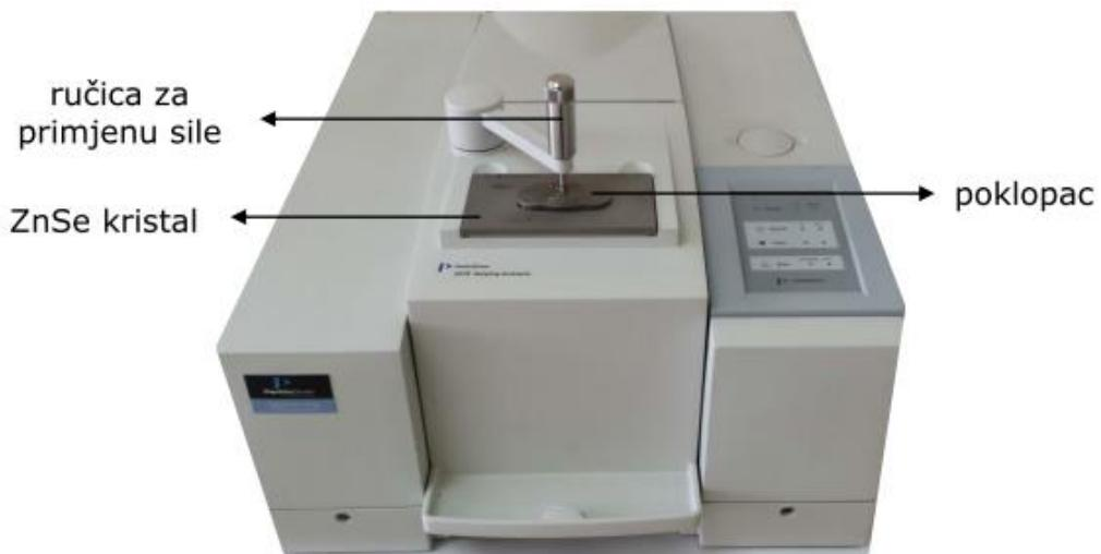
**Slika 13.** FT-IR spektrometar Spectrum One (Perkin–Elmer) s dodatkom za snimanje HATR tehnikom.<sup>37</sup>
