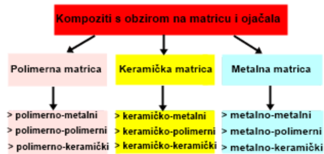
Slika 3. Podjela kompozita s obzirom na matricu i ojačala 11
