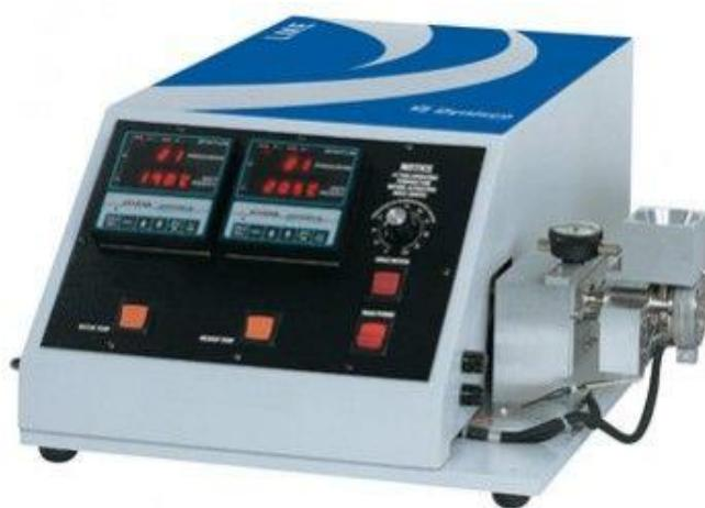
**Slika 12.** Laboratorijski jednopužni ekstruder Dynisco (Qualitest, SAD)
