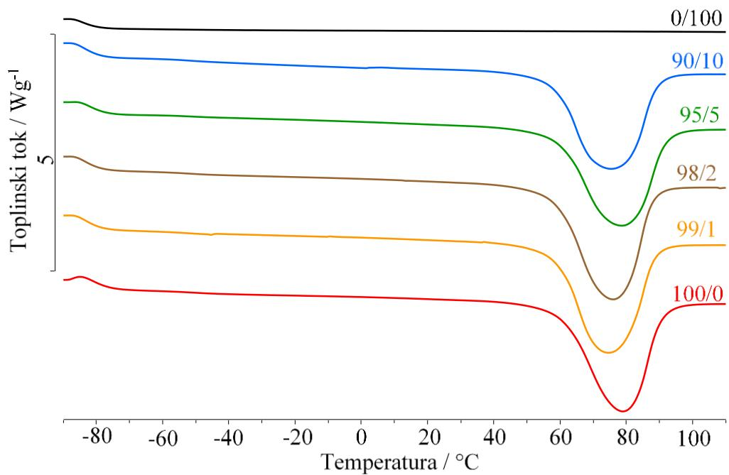
**Slika 33.** Usporedba normaliziranih DSC krivulja (drugo zagrijavanje) uzoraka kompozita PEO/ES svih sastava
