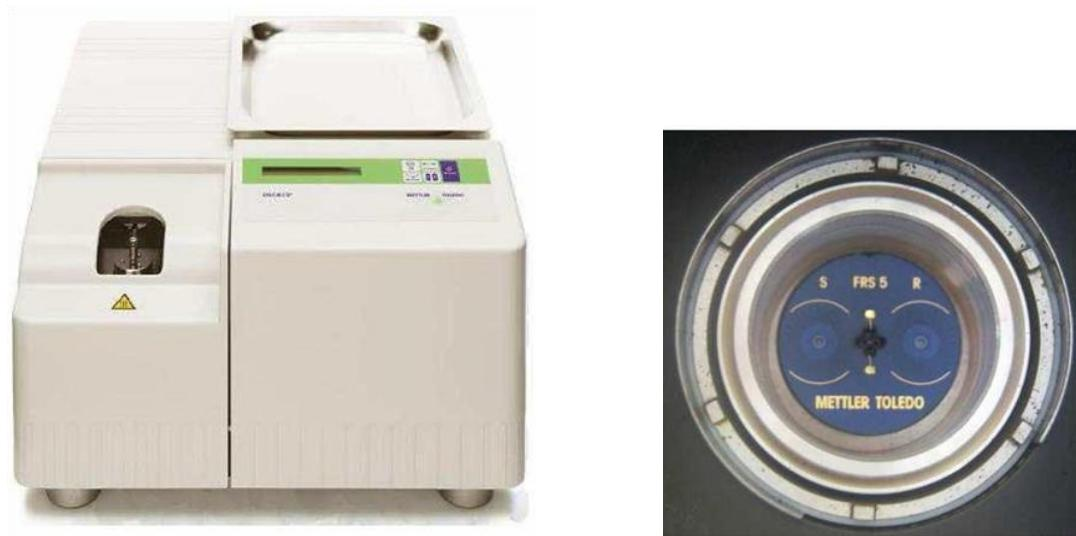
**Slika 14.** a) Diferencijalni pretražni kalorimetar DSC 823<sup>e</sup> (Mettler Toledo, Švicarska) i
