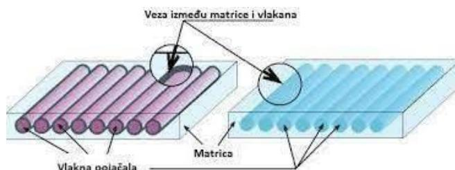
Slika 2. Struktura kompozita<sup>10</sup>
