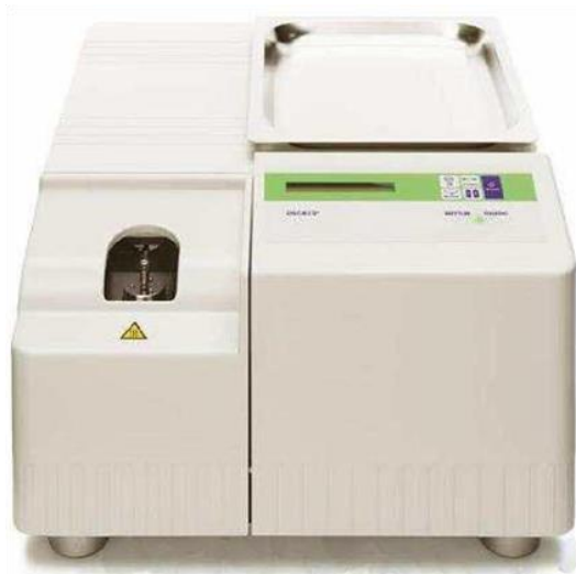
Slika 14. a) Diferencijalni pretražni kalorimetar DSC 823 e (Mettler Toledo, Švicarska) i b) mjerno osjetilo 37
