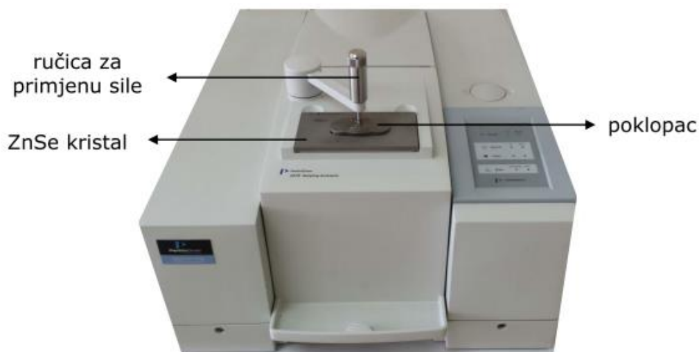
Slika 13. FT-IR spektrometar Spectrum One (Perkin-Elmer) s dodatkom za snimanje HATR tehnikom. 37
