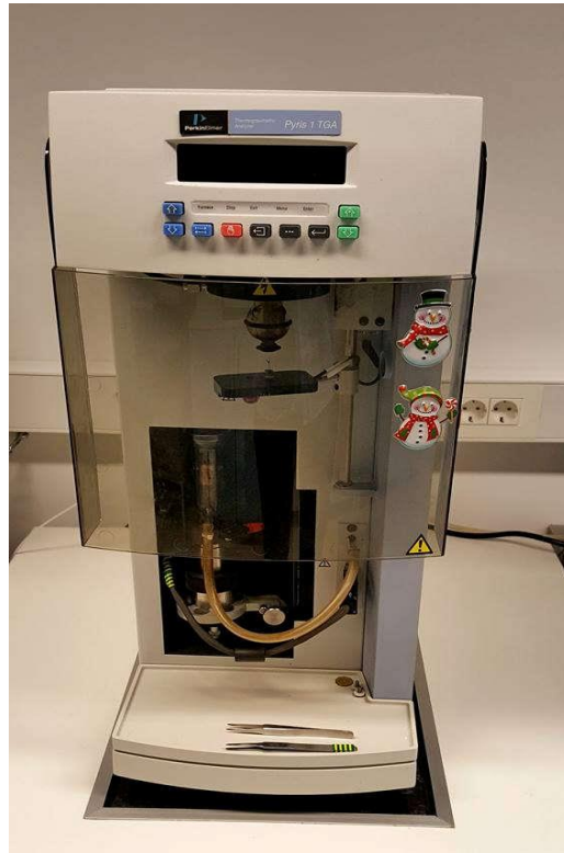
Slika 16. Termogravimetar Pyris 1 TGA
