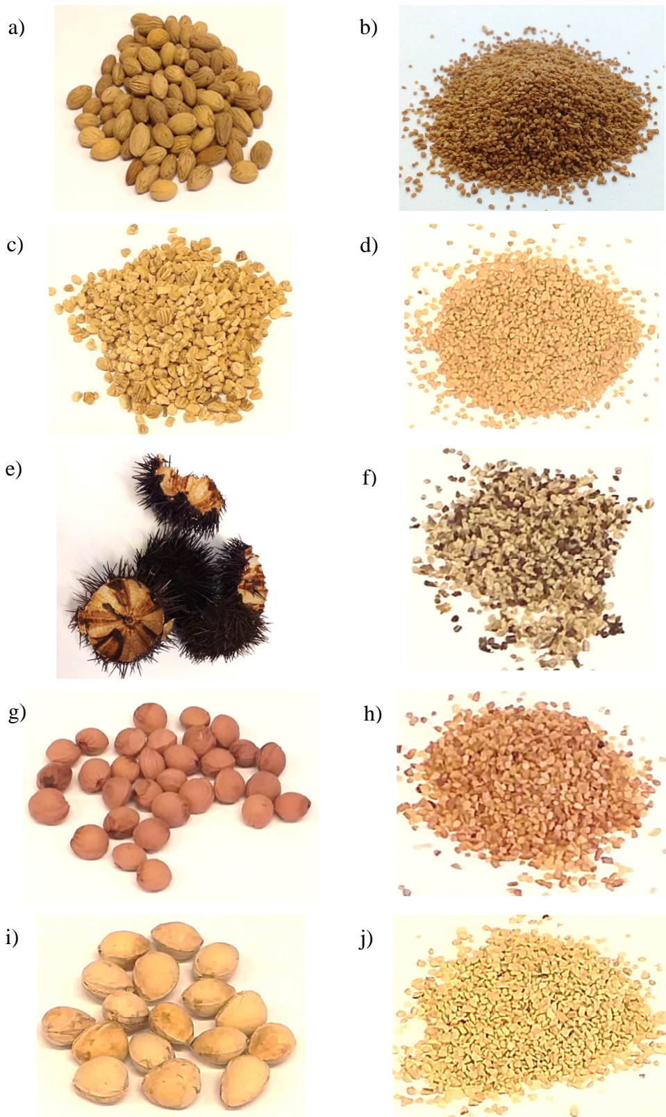
Slika 2.6 Sakupljeni i pripremljeni biosorbenti: a, b) čitave i usitnjene koštice maslina; c, d) krupni i usitnjeni pelet komine masline; e, f) krupni i usitnjeni ostaci hridinskog ježinca; g, h) čitave i usitnjene koštice višnje; i, j) čitave i usitnjene koštice trešnje 69
