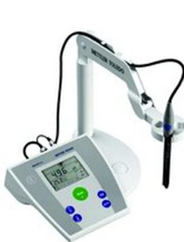
Slika 2.1 pH metar „Mettler Toledo“
