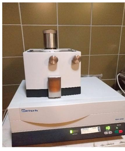
Slika 2.4 Kuglični mlin „Retsch RM 200“
