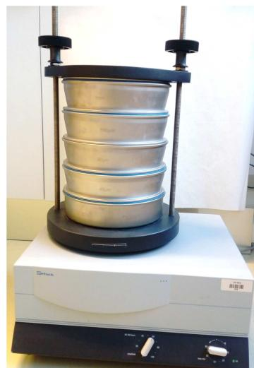
Slika 2.5 Uređaj za prosijavanje „Retsch AS 200 basic“
