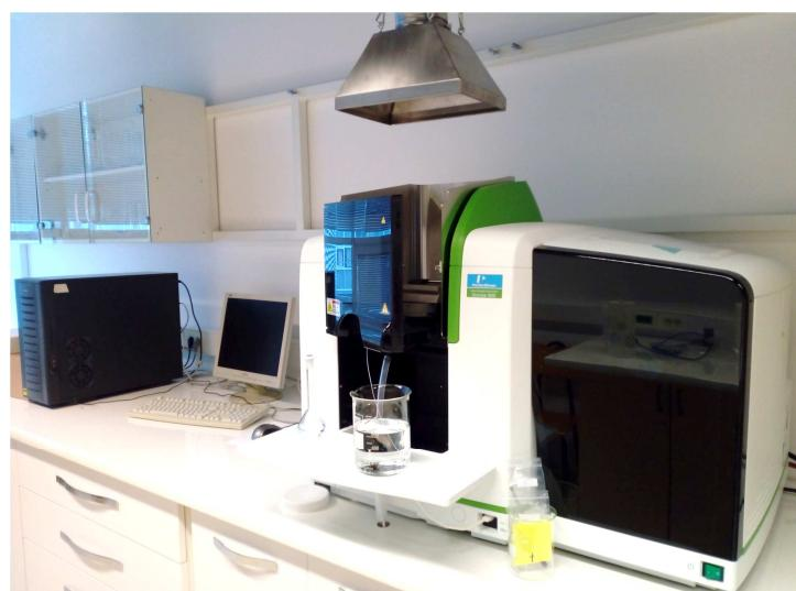
Slika 2.12 Atomski apsorpcijski plameni spektrometar PinAAcle 900F
