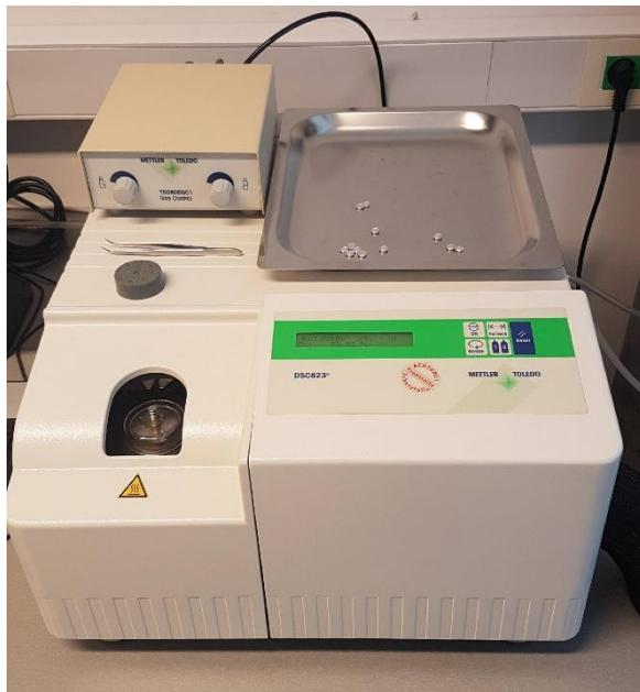
Slika 25. Diferencijalni pretražni kalorimetar DSC 823<sup>e</sup> (Mettler Toledo)
