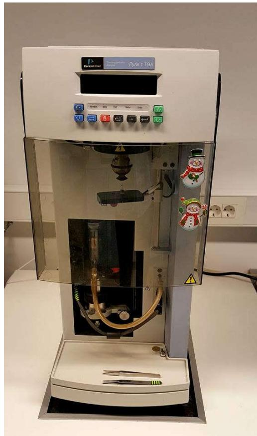
Slika 27. Termogravimetar Pyris TGA
