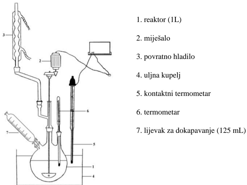
Slika 23. Aparatura za sintezu poli(vinil-alkohola)<sup>3</sup>
