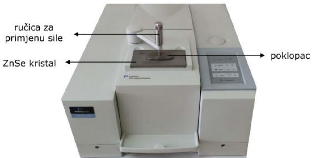
Slika 24. FT-IR spektrometar Spectrum One (Perkin–Elmer) s dodatkom za snimanje HATR tehnikom<sup>26</sup>
