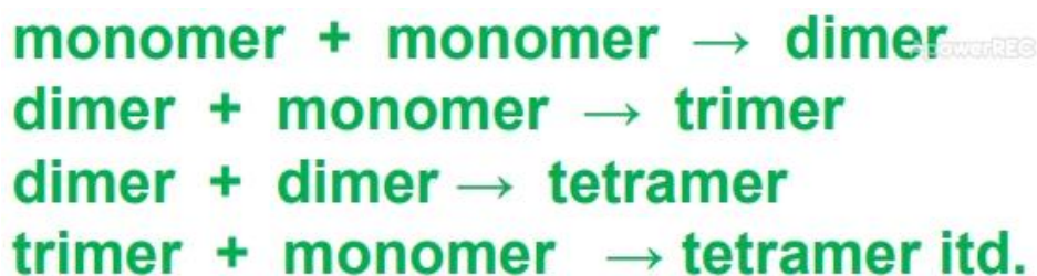
Slika 7. Prikaz mehanizma stupnjevite polimerizacije 13
