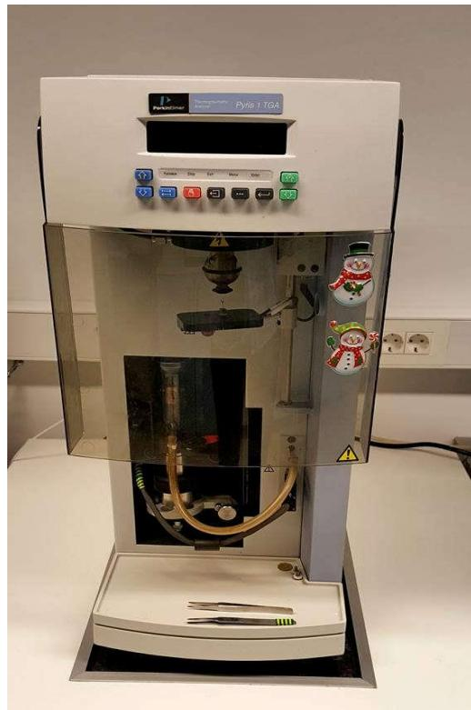
Slika 19. Termogravimetar Pyris TGA
