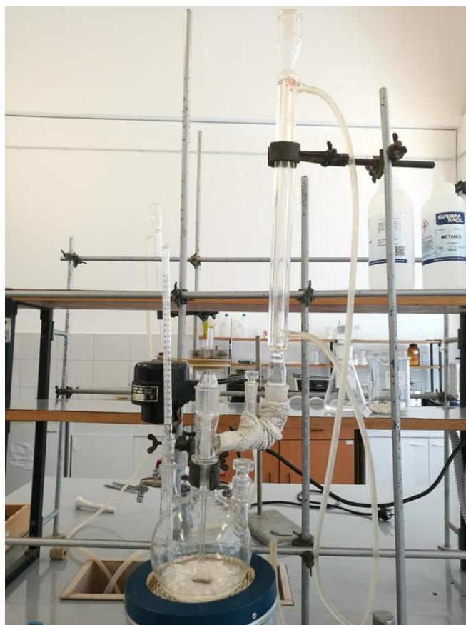
Slika 15. Aparatura za emulzijsku polimerizaciju vinil-acetata
