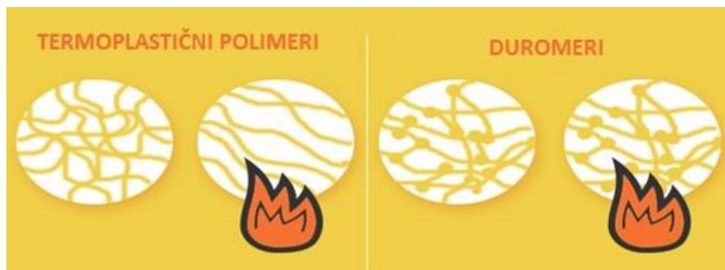
Slika 2. Ponašanje termoplastičnog polimera i duromera tijekom zagrijavanja.<sup>6</sup>
