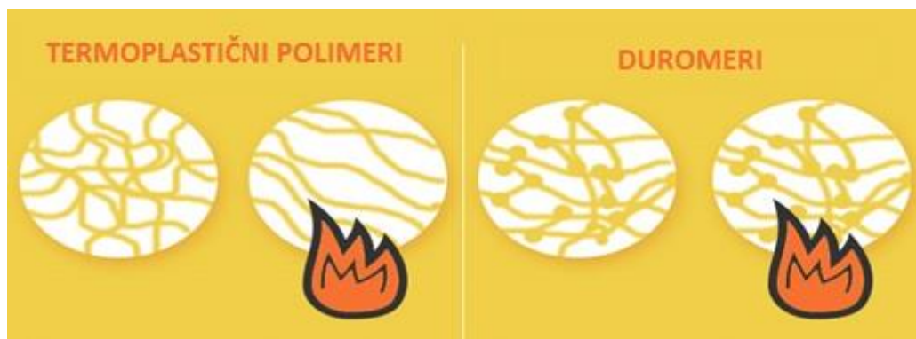
Slika 2. Ponašanje termoplastičnog polimera i duromera tijekom zagrijavanja. 6
