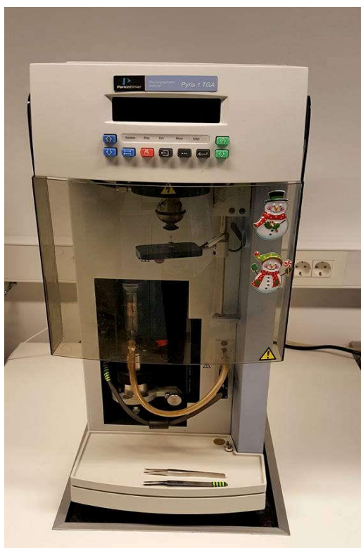
Slika 19. Termogravimetar Pyris TGA
