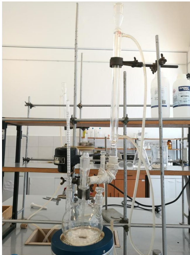
Slika 15. Aparatura za emulzijsku polimerizaciju vinil-acetata
