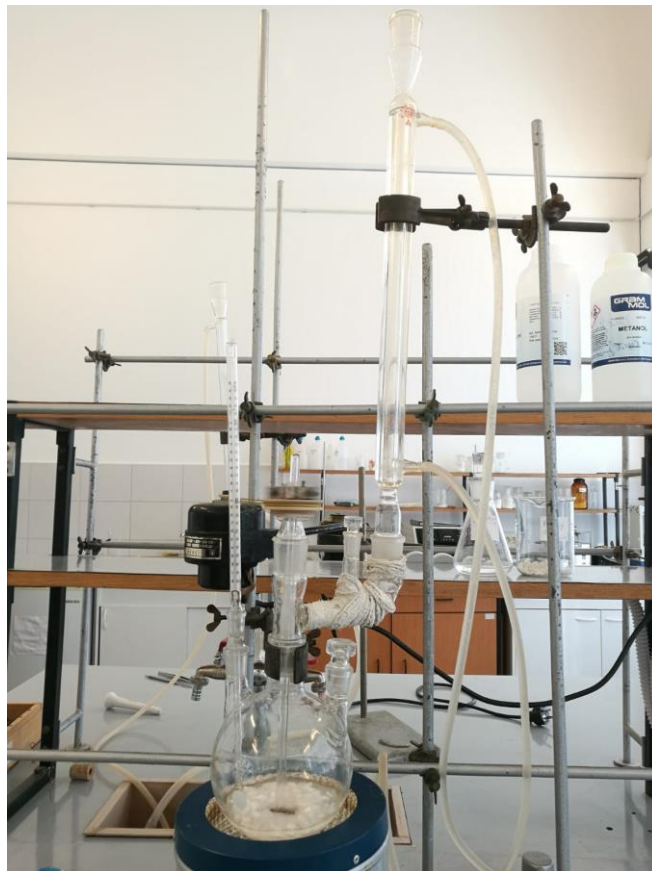
Slika 15. Aparatura za emulzijsku polimerizaciju vinil-acetata
