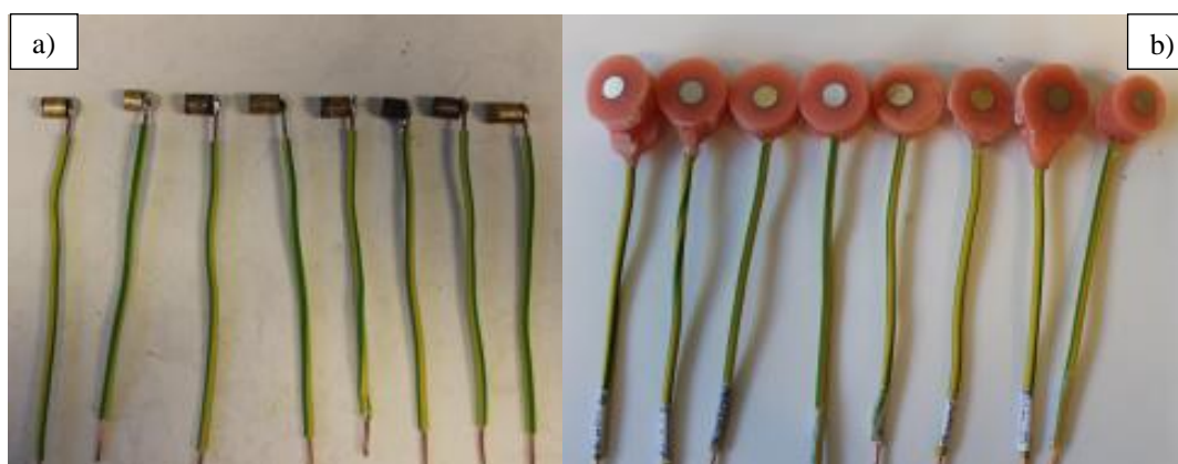
Slika 15. Izrada elektroda za elektrokemijska mjerenja
