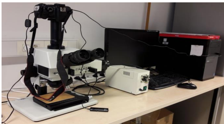
Slika 18. Svjetlosni mikroskop MXFMS-BD, Ningbo Sunny Instruments co. povezan s računalom
