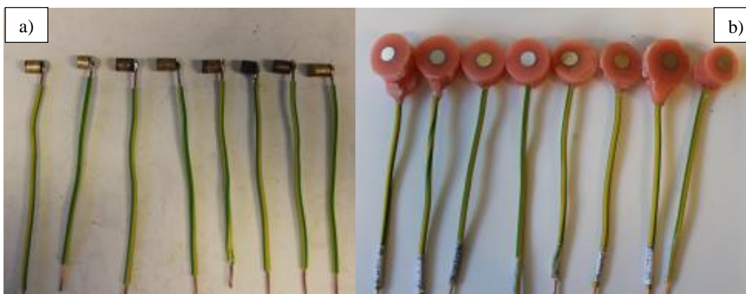
Slika 15. Izrada elektroda za elektrokemijska mjerenja
